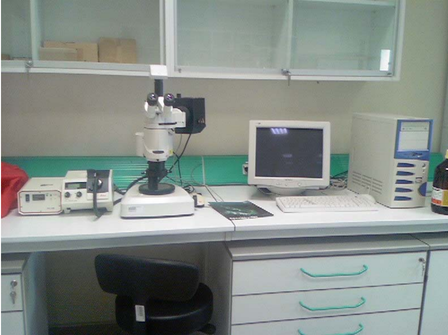
Resim 5: Stereomikroskop (Leica MZ 16 FA)
