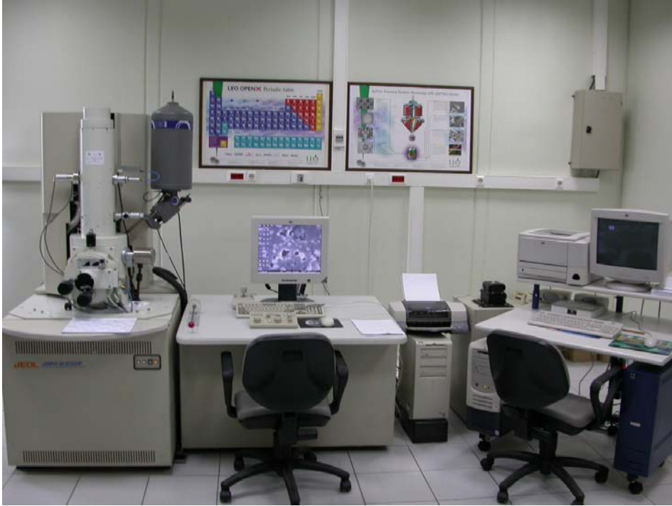
Resim 6: Scanning Electron Mikroskop (SEM-FEGSEM 6335-F)
