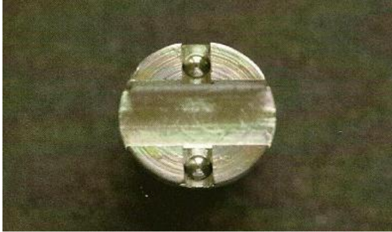
Resim 22: Zirkonya Blokları Yerleřtirdiđimiz Düzenek
