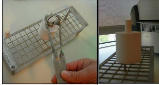
Resim 3.1.1.10: Manşete seramik tablet ve AIO 2 itici piston yerleştirilmesi
