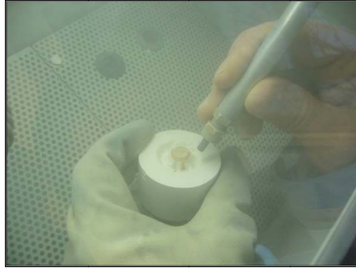
Resim 3.1.1.16: Numunelere yakın revetman artığının uzaklaştırılması
