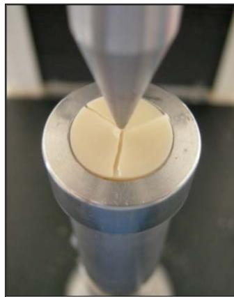
Resim 3.5.3: Biaksiyel bükme testi sonrası örnek
