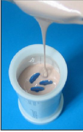
Resim 3.1.1.5: Manşete revetmannin dökülmesi kapatılması
