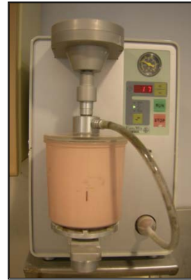
Resim 3.1.1.4: Vakum altında revetmanın karıştırılması
