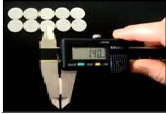
Resim 22. Dijital kumpas ile örneklerin ilk kalınlıkların ölçümü.
