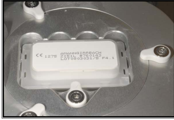
Resim 17. Kazıma ünitesine yerleştirilen Ceramill blok.
