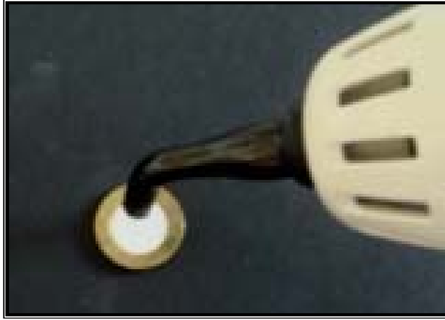
Resim 4. Kompozit kalıbın ışınla polimerize edilmesi.
