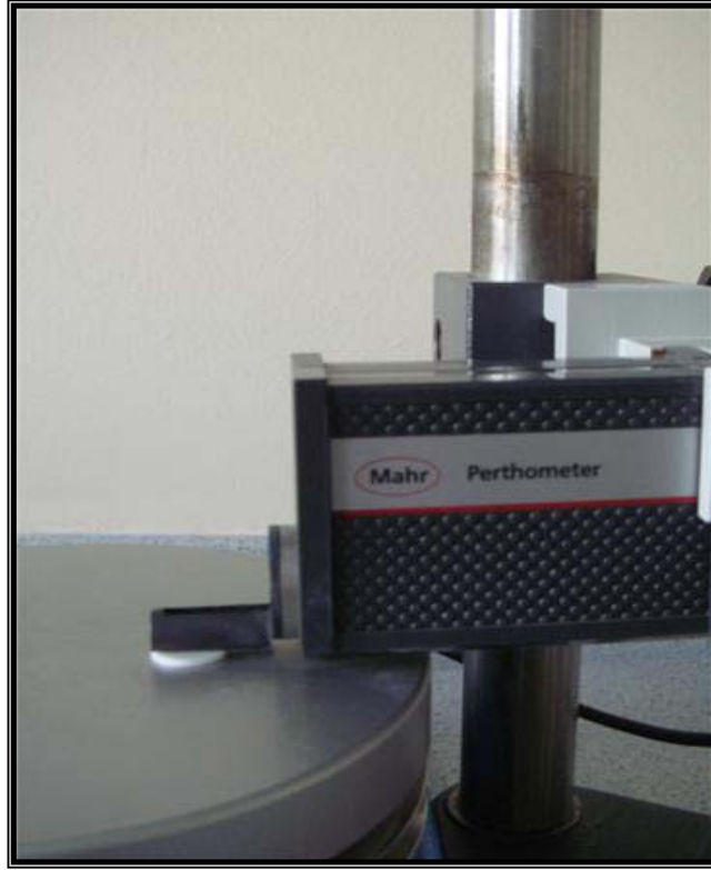
Resim 25. Yüzeý pürüzsüzlük ölçümü.
