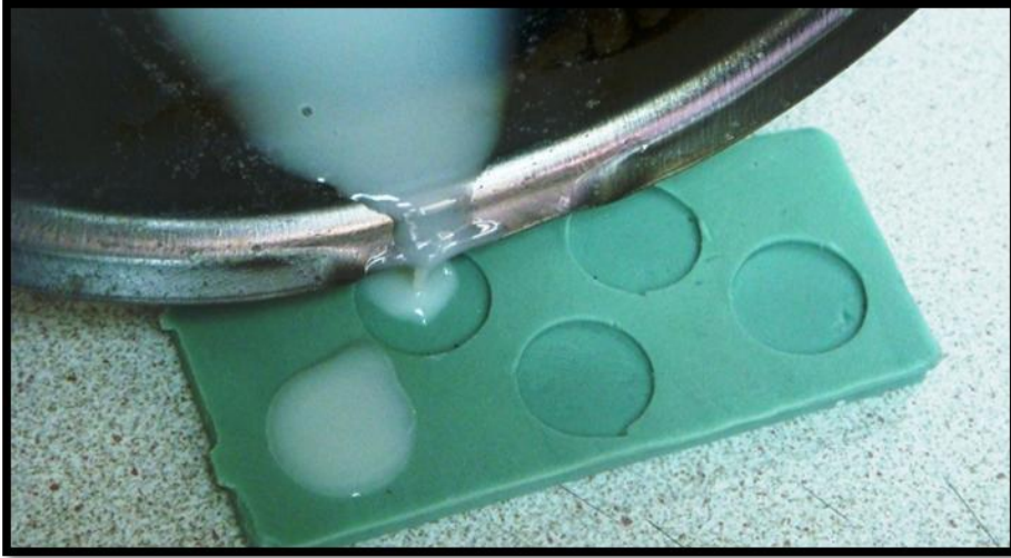
Resim 20: Modelaj mumunun ısıtılıp ana modele dökülmesi
