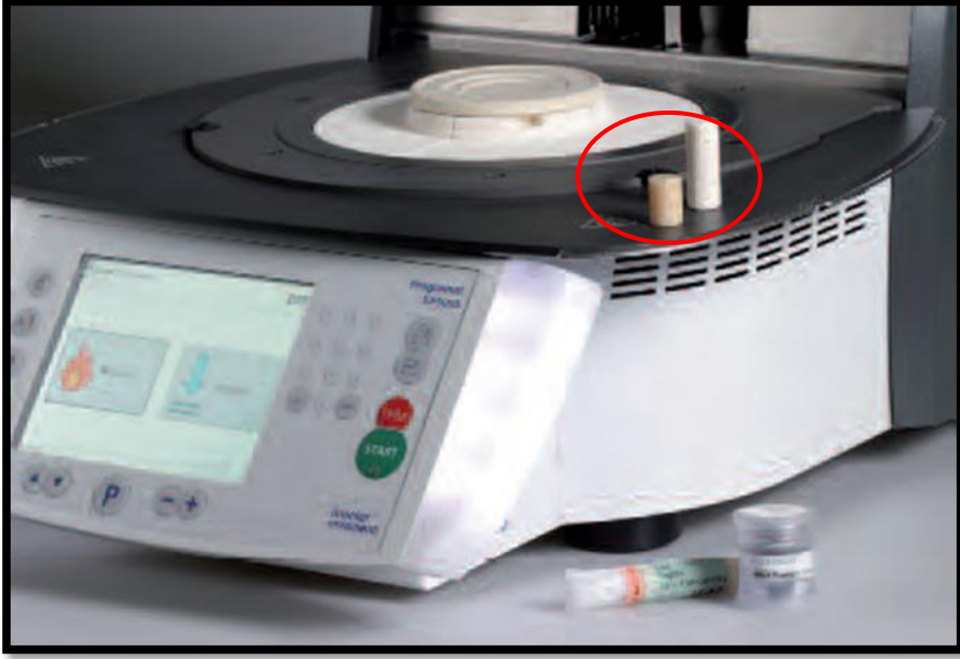
Resim 39: IPS e.max Press seramik tablet ve IPS Alox Plunger (itici piston)
