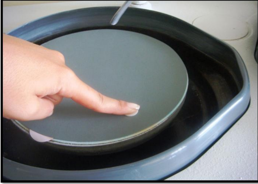
Resim 57: Parmak basıncı ile yüzey işlemleri yapılması
