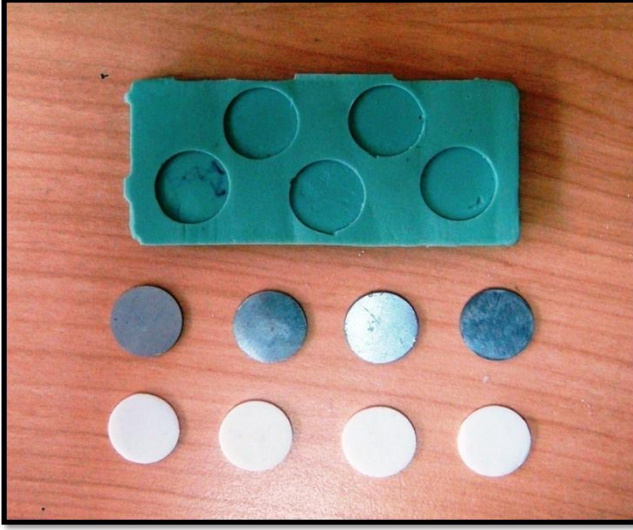
Resim 22: Metal diskler, ana model ve mum modeller
