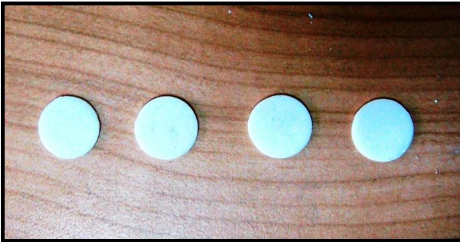
Resim 21: Modelaj mumu sertleştikten sonra çıkartılan mum örnekler
