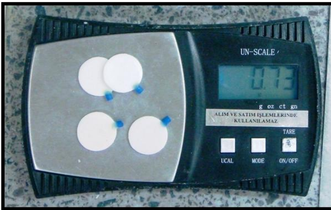
Resim 23: Mum ağırlıklarının ölçülmesi
