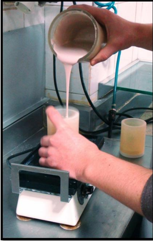
Resim 31: Revetmanın dökülmesi ve hava kabarcıklarının çıkartılması
