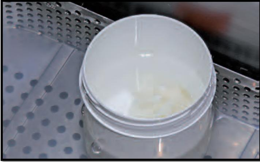
Resim 52: IPS e.max Press Invex Liquid içerisinde bekletilen örnekler
