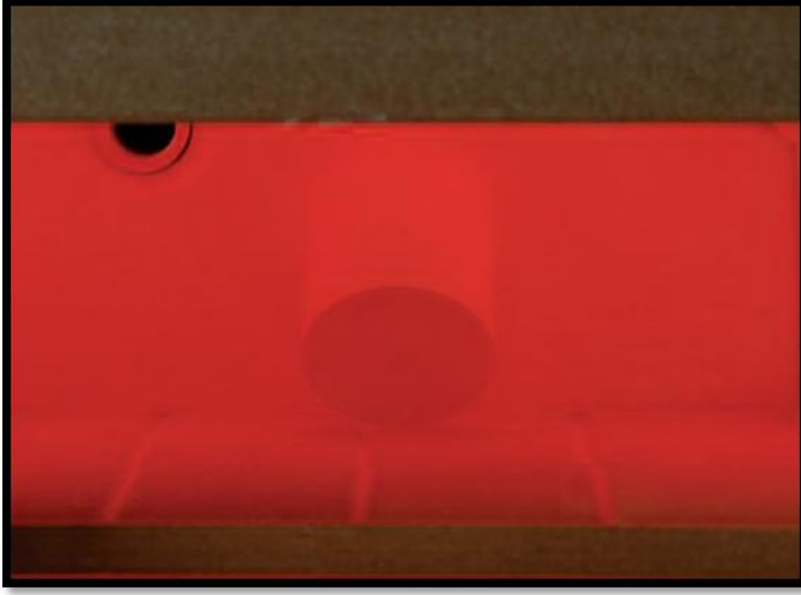
Resim 35: Manşetin ön ısıtma fırınındaki eğilendirilmiş duruşu
