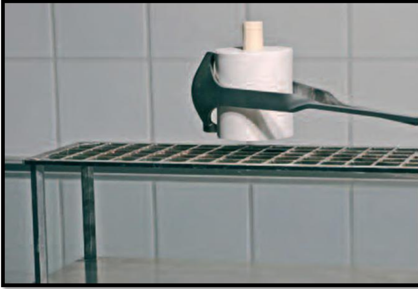
Resim 44: Fırından çıkarılan sıcak manşetin soğumaya bırakılması
