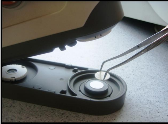
Resim 60: Örneklerin spektrofotometreye yerleştirilmesi
