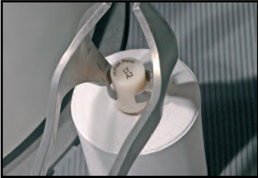
Resim 40: IPS e.max Press seramik tablet sıcak manşete yerleştirilirken
