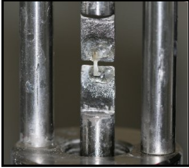
Resim 15: Elde edilen çubuklarının universal test cihazına bağlanması
