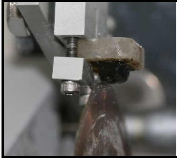
Resim 13: İzomet ile dişlerin mesiyo-distal ve vestibulo-lingual/palatal yönde kesilmesi
