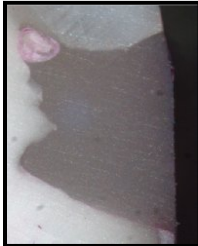
Resim 28: Stereomikroskop altında lazer ile hazırlanmış Adper SE Plus-Z250 ile restore edilmiş grupta oklüzalde 'sızıntı yok, gingivalde 'orta dereceli sızıntı' görüntüsü (X50).
