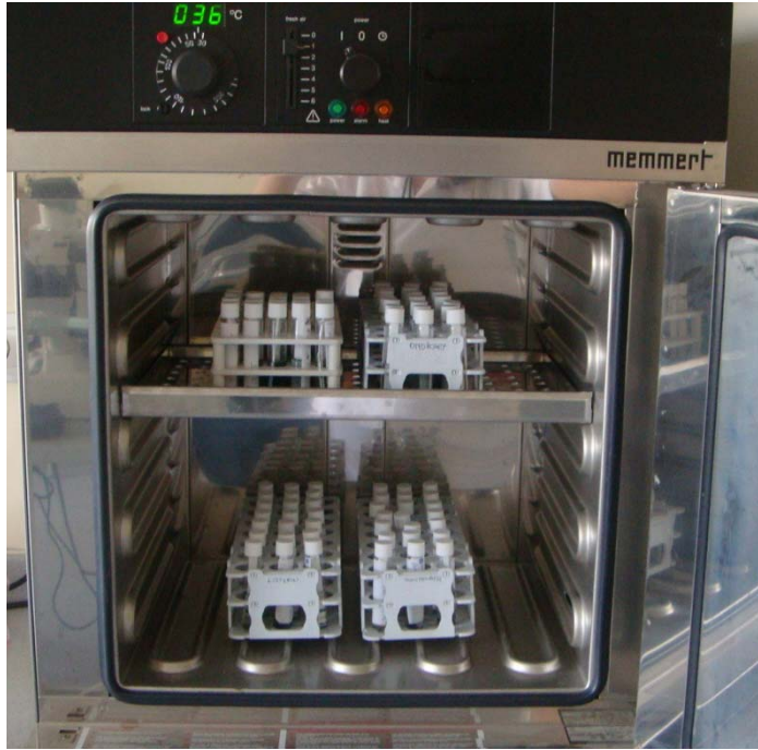
Resim 3.9. Test örneklerinin bekletildiği etüv
