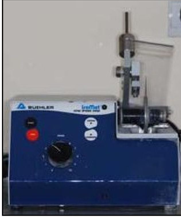
Resim 3: Kesit Alma Cihazı (Isomet, Buehler, IL, ABD)
