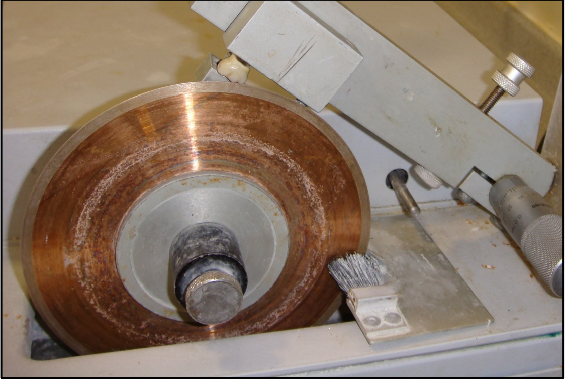
Resim 4a: Kesim İin Kullanılan Elmas İnce Bıak
