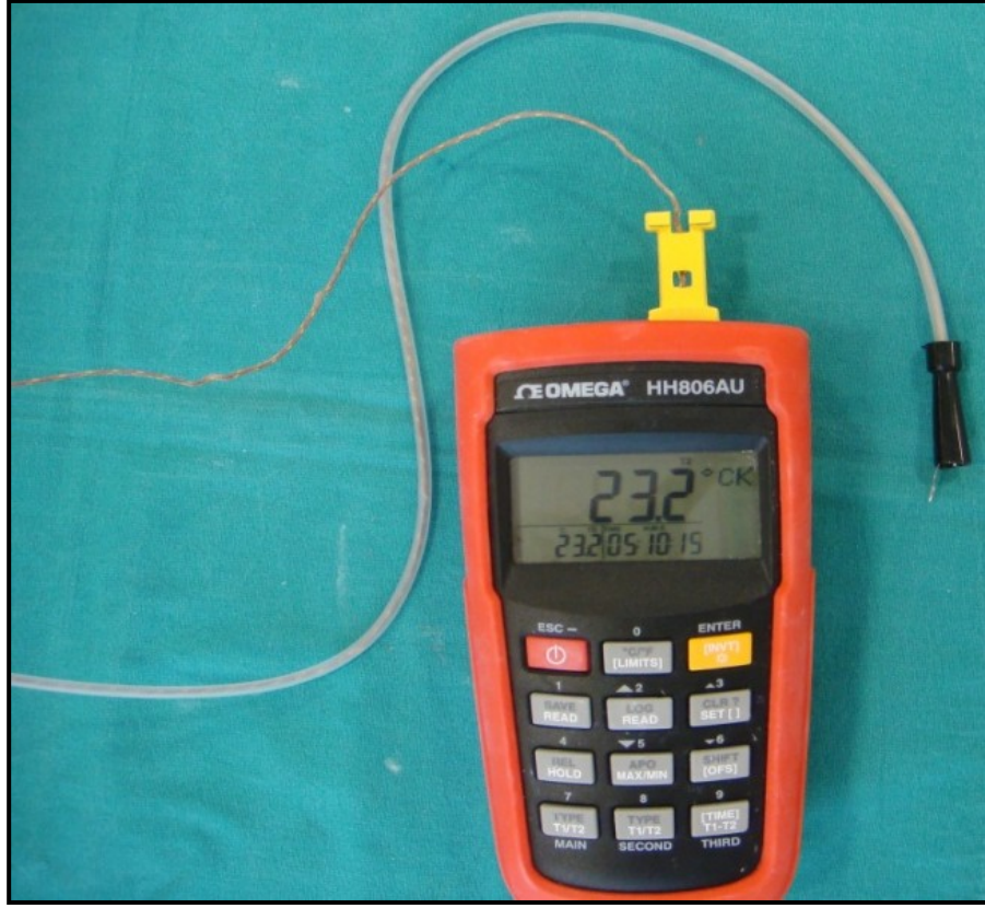
Resim 17: Plastik Bir Borunun (Aspirasyon Katateri, Bıçakçılar, İstanbul, Türkiye) İçerisinden Gerçirilen Termoçiftin Bağlandığı Dijital Termometre
