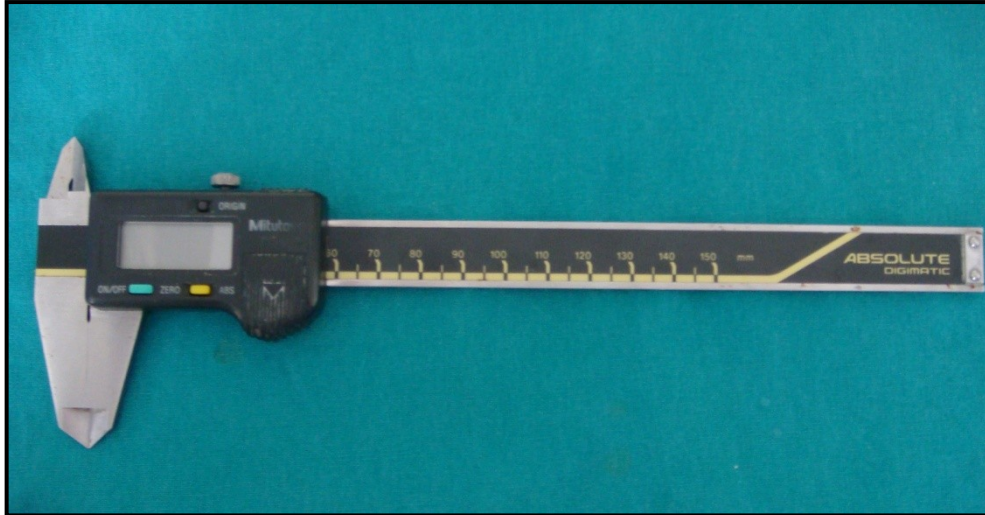
Resim 8: Örneklerdeki Pulpa Odası Uzaklıklarının Ölçülmesinde Kullanılan Dijital Kumpas
