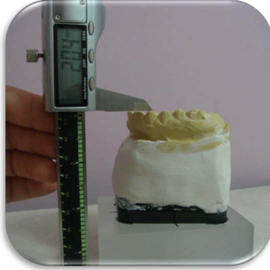
Resim 3.39. Şekil 3.4.'deki “d + g” mesafesinin dijital tabla üzerinde modelde ölçülmesi.
