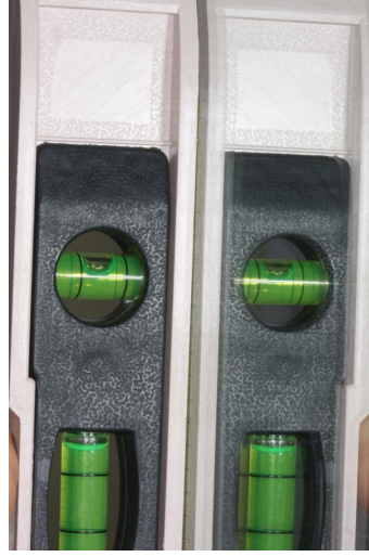
Resim 3.22. Su terazisi ile yere dik konumda olduğu tespit edilmiş ayna.
