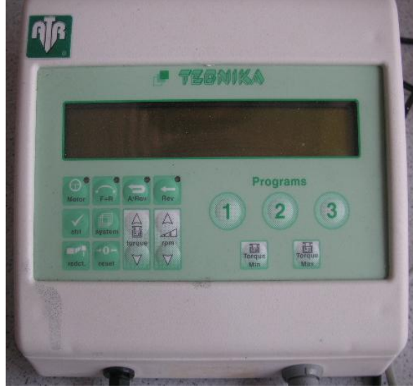
Resim 34. ATR Tecnica Torque Control Motor
