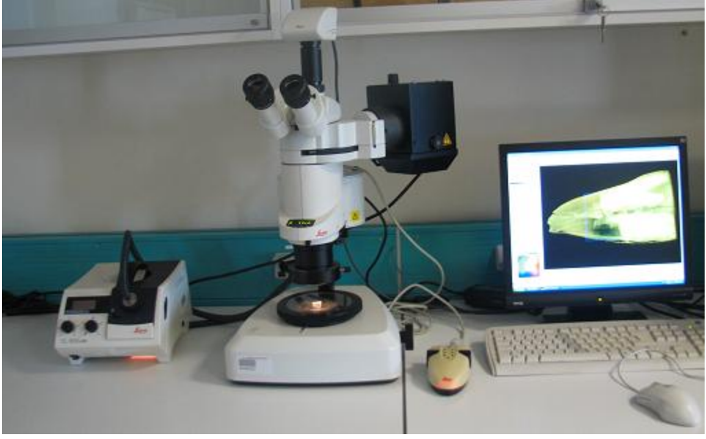
Resim 43. İkiye bölünen dişlerin incelendiği Leica DFC320 stereomikroskobu
