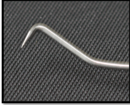
Resim 5: Quick 2 braketinin açma ve kapama el aleti.
