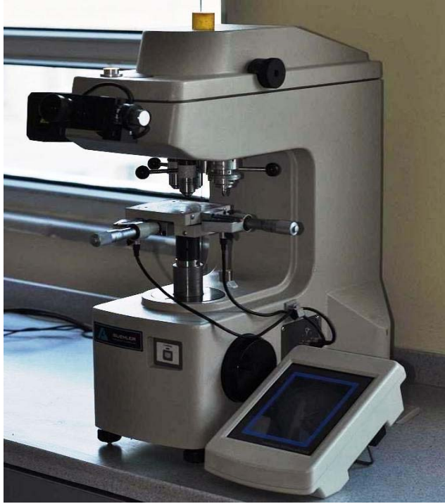
Resim 12: Çalışmada kullanılan Buehler Vickers sertlik ölçüm cihazı.
