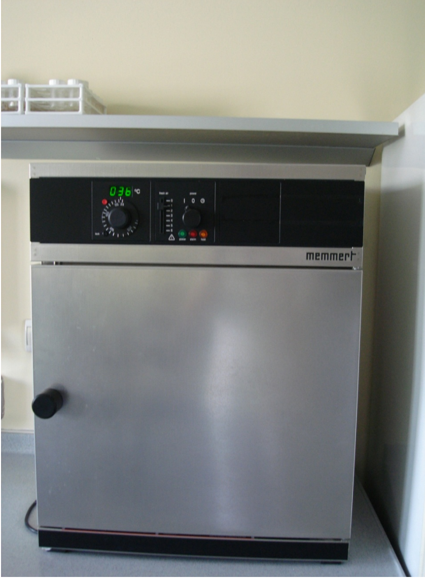
Resim 9: Çalışma süresince örneklerin bekletildiği etüv.
