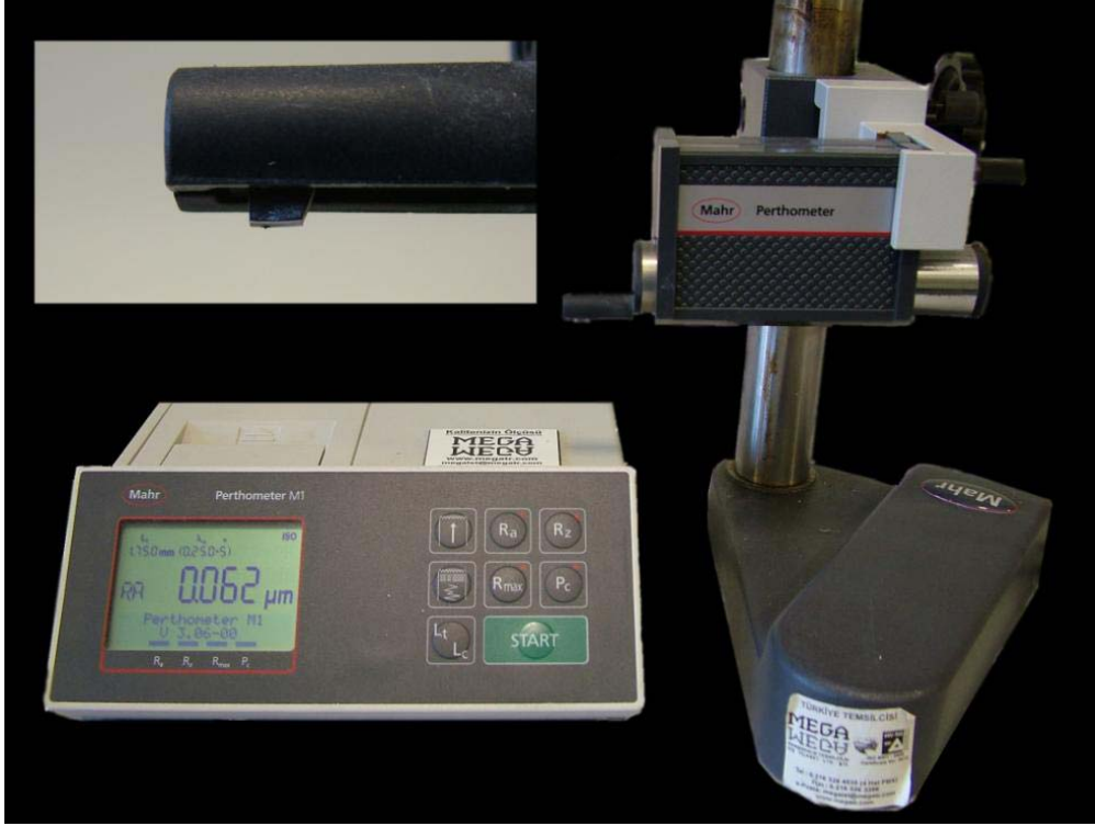
Resim 11: Örneklerin yüzey pürüzlülüğünü ölçmek için kullanılan yüzey profilometresi.
