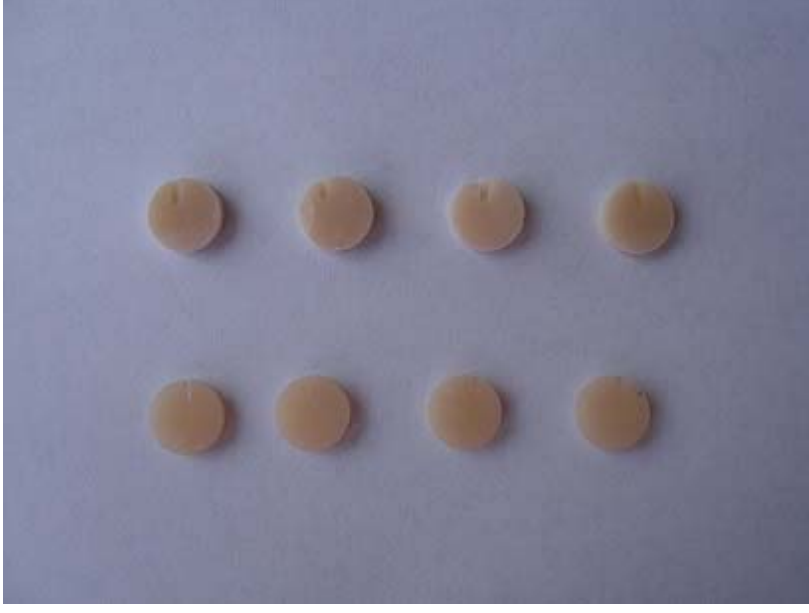
Resim 6: Fuji IX GP Extra ve Kalore materyalinden hazırlanan örnekler.
