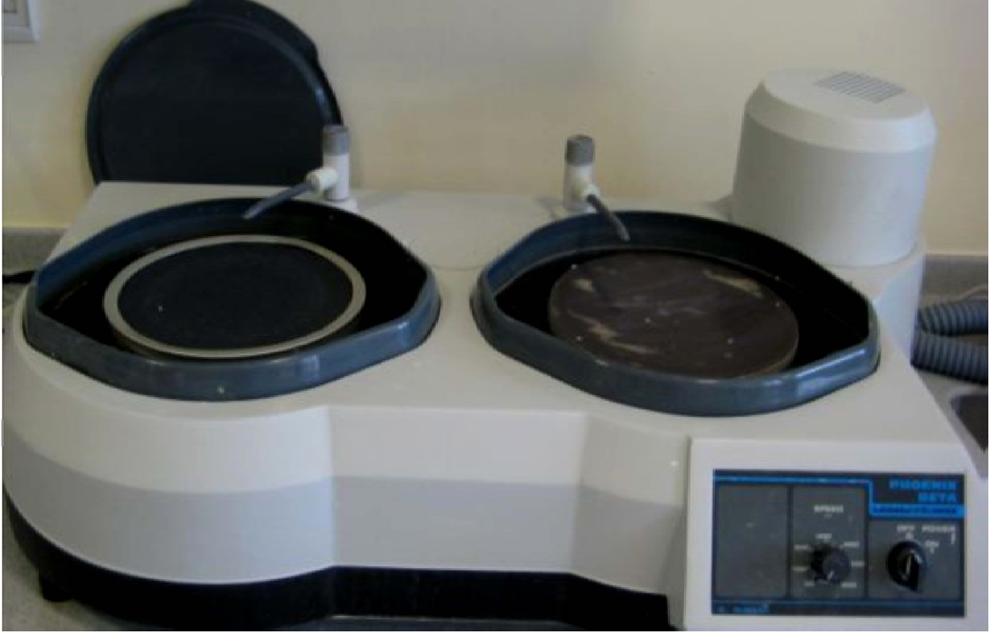
Resim 8: Çalışmada kullanılan polisaj cihazı (Phoenix Beta Grinder/ Polisher, Buehler, Germany)
