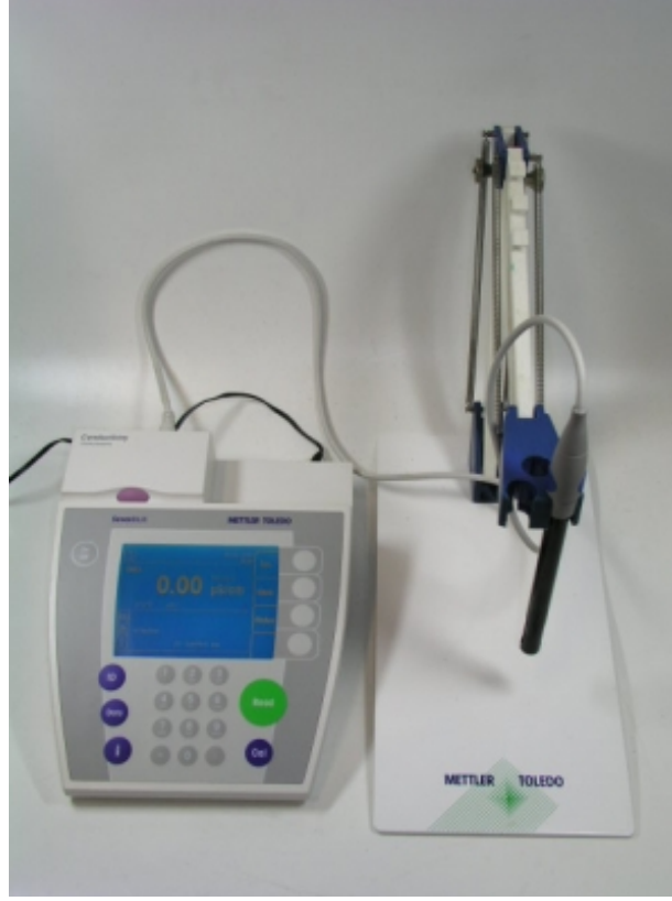
Resim 10 : Çalışmada kullanılan pH metre cihazı (Seven Multi Metter Toledo GmbH 8603).
