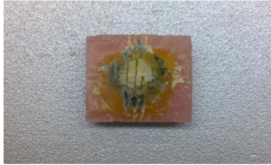
Resim 19: Mikrotensile bağlanma dayanımı için hazırlanan 1x1 mm boyutundaki dentin-indirekt kompozit çubukları.
