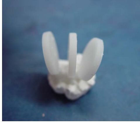
Resim 18: Kumlama sonrası tıjlı numuneler
