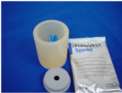
Resim 25: Döküm dairesine yerleştirilmiş tijli mum numuneler
