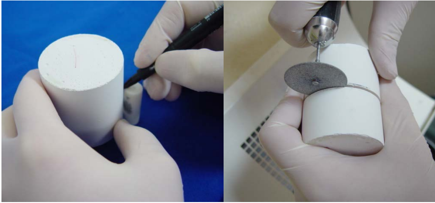
Resim 16: Alüminyum itici piston mesafesi kadar işaretlenip kesilmesi
