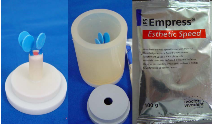
Resim 9: Silikon halkaya sabitlenmiş ve manşete alınmış mum numuneler
