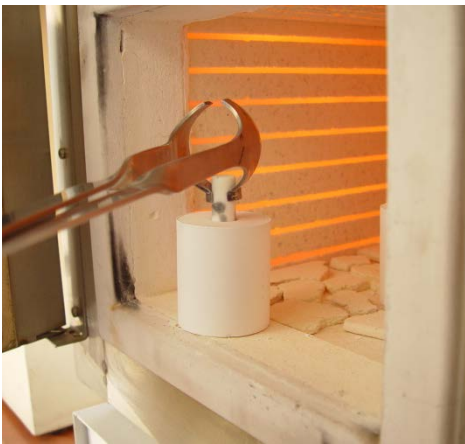
Resim 14: Mum uçurma fırınından çıkarılmış piston ve manşet
