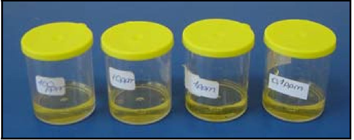
Resim 13. Standart fluorid solüsyonundan deiyonize su ile seyreltilerek elde edilen 100, 10, 1 ve 0,1 ppm'lik solüsyonlar
