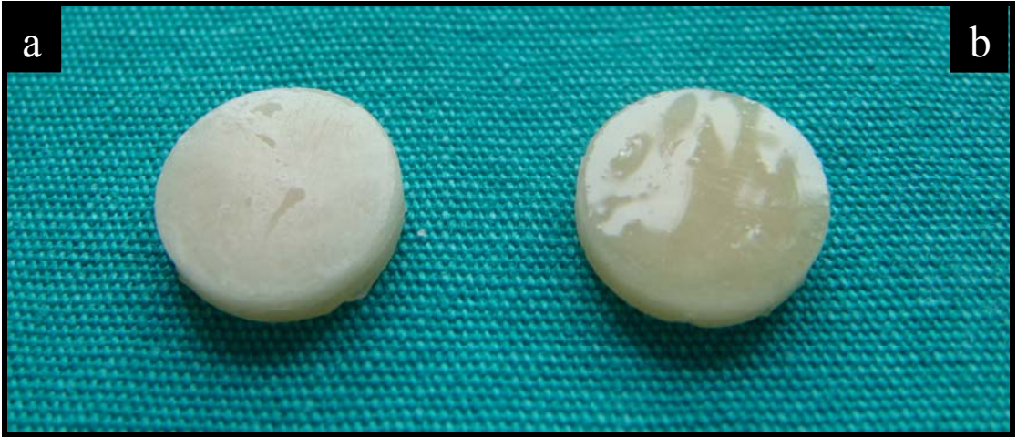
Resim 21. Easy Glaze uygulanmamış (a) ve uygulanmış (b) örneklerin yüzey görüntüleri
