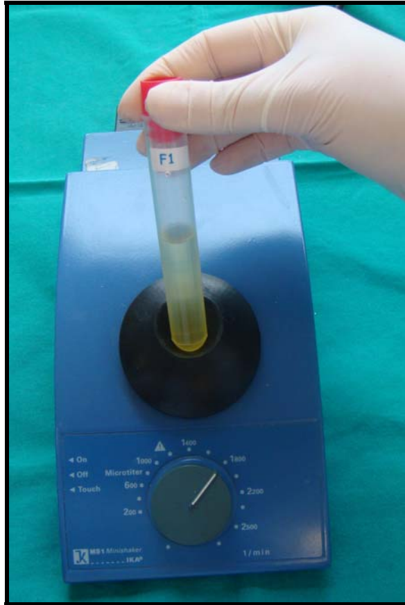
Resim 14. Hazırlanan solüsyonların ölçümden önce karıştırıldığı ısıtıcısız karıştırıcı cihazı. (IKA magnetik karıştırıcı)
