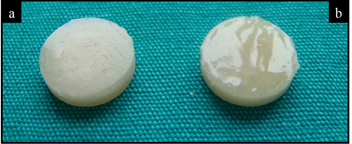
Resim 19. G-COAT PLUS uygulanmamış (a) ve uygulanmış (b) örneklerin yüzey görüntüleri
