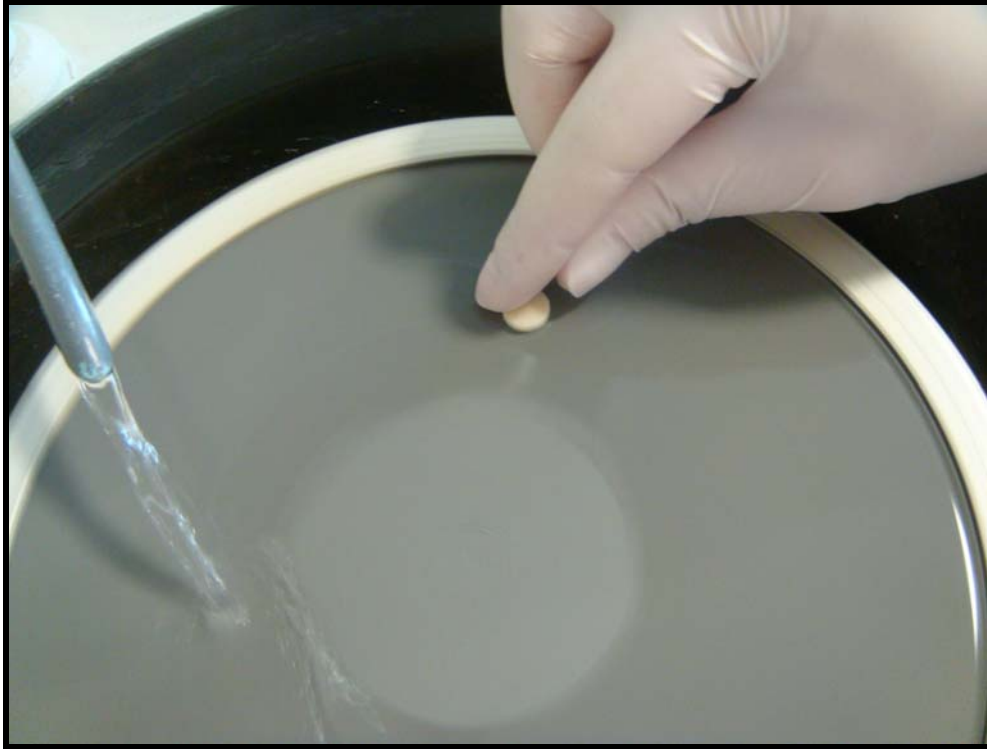
Resim 17. Örneklerin Buehler Phoenix Beta Grinder-polisher cihazında 1200 grid silikon karbit kâğıt zımpara disk ile su altında zımparalanması
