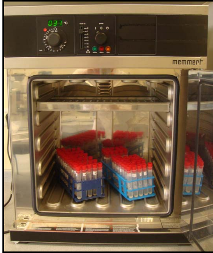
Resim 12. Çalışmada örneklerin bekletildiği 37°C'lik etüv
