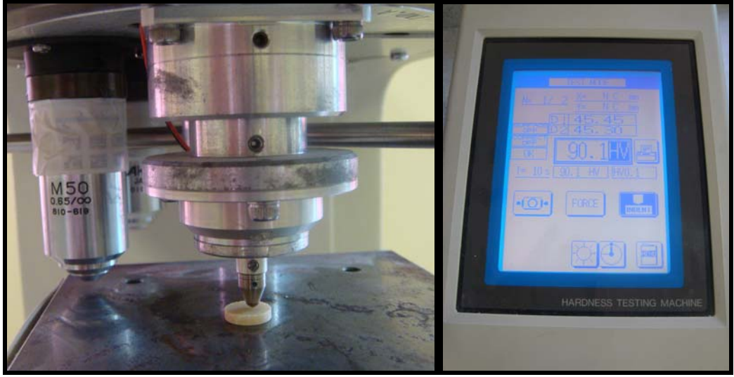
Resim 23. Örneğin belirlenmiş yüzeyinde Buehler Hardness Testing Machine cihazının kuvvet uygulayıcı ucu ile çentik oluşturulması ve Vickers sertlik değerinin hesaplanması
