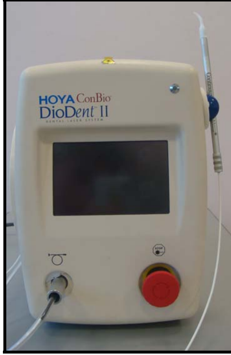
Resim 14. Çalışmada kök kanal dezenfeksiyonunda kullanılan Diod lazer cihazı (HOYA ConBio Diodent II).
