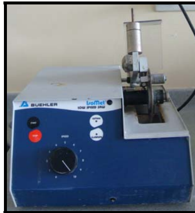
Resim 1. Çalışmada diřlerin kuronlarını köklerinden ayırmak için kullanılan IsoMet® 1000 Precision Sectioning Saw (Buehler, Lake Bluff, IL,USA) marka hassas testere.
