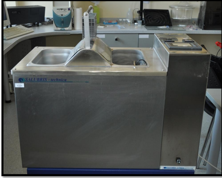
Resim 3.13: Çalışmada kullanılan termosiklus cihazı; Salubris Technica, Türkiye
