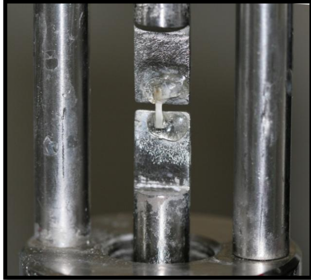
Resim 3.17: Elde edilen çubukların Universal test cihazına bağlanması
