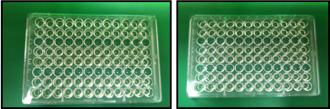
Resim 8, 9. 96 kuyucuklu steril mikropleyt kuyucuklarında çalışma grupları için ikişer sıra BHI buyyon kullanılarak 200 µl'lik hacimde iki katlı sulandırmaları
