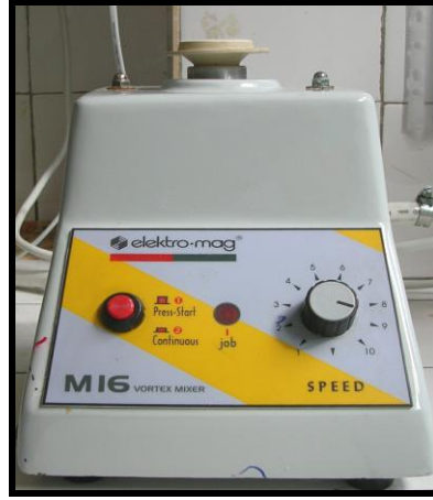
Resim 27. Cam tüpe aktarılan hidroksiapatit disklerin 1 dakika boyunca vortexlenmesi (Elektro.mag MIG)
