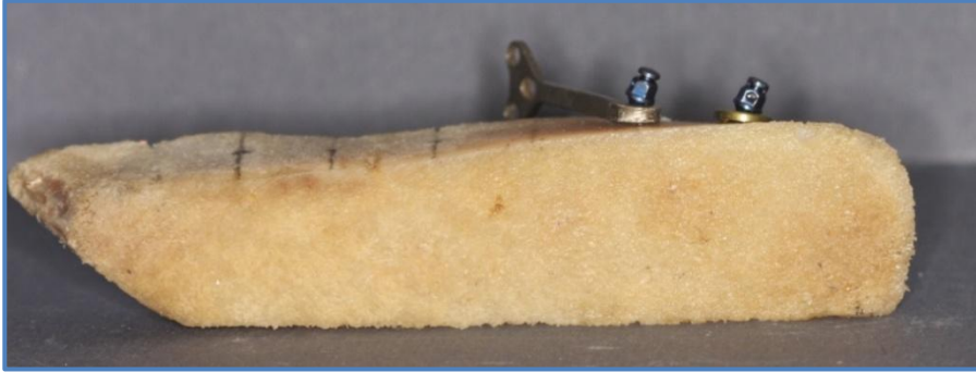
Resim 3.20.a. Özel aparat yardımı ile 2 mm'lik mesafenin bırakılması (Normal minivida grubu 70° yerleřtirme açısı)
