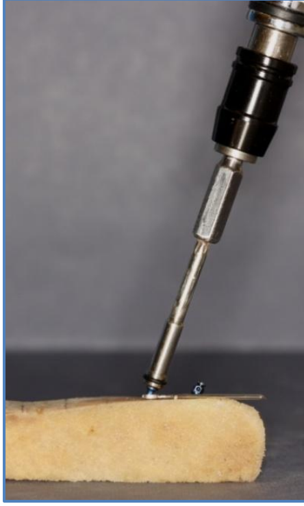
Resim 3.20.c. 1 mm'lik aparatın yerleştirilmesi ve maksimum yerleştirme torkunun ölçülmesi (Normal minivida grubu 70° yerleştirme açısı)
