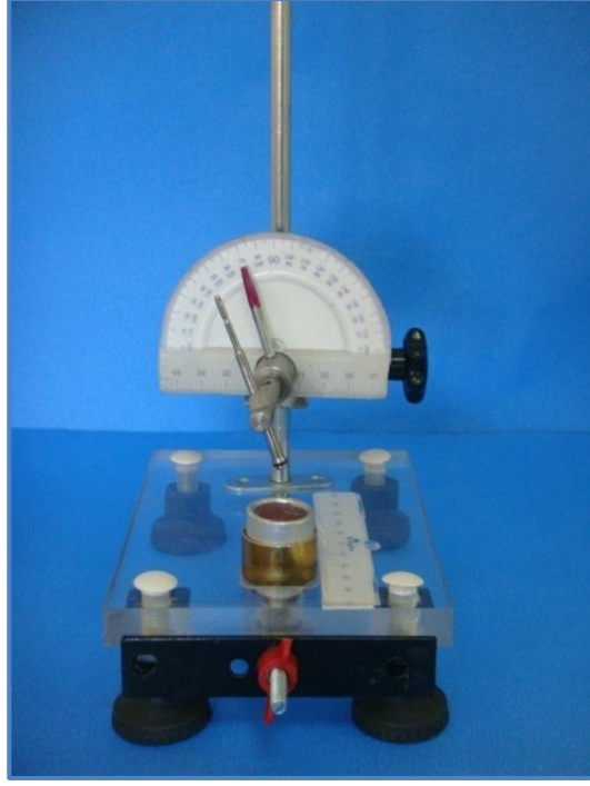
Resim 3.26. Örneklerin akrilikle bloklanması için geliştirilen açılı düzenek
