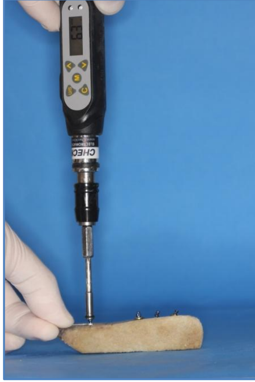
Resim 3.20.e. 1 mm'lik aparatın yerleştirilmesi ve maksimum yerleştirme torkunun ölçülmesi (Normal minivida grubu 90° yerleştirme açısı)
