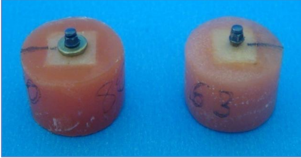
Resim 3.28.a. Kuvvet testi cihazına aktarılmak üzere hazırlanmış örnekler
