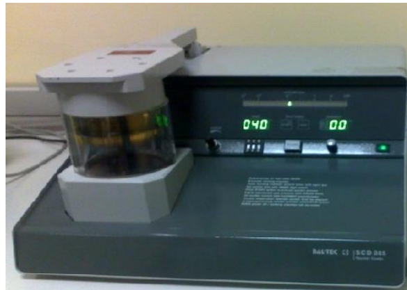
Resim 11. SEM görüntülemesi öncesinde dişlerin kaplandığı altın kaplama cihazı
