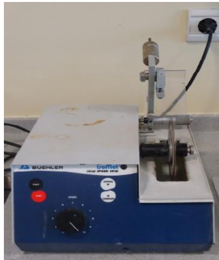
Resim 3. Örnek dişleri 17 mm uzunlukta kesmede kullanılan hassas testere
