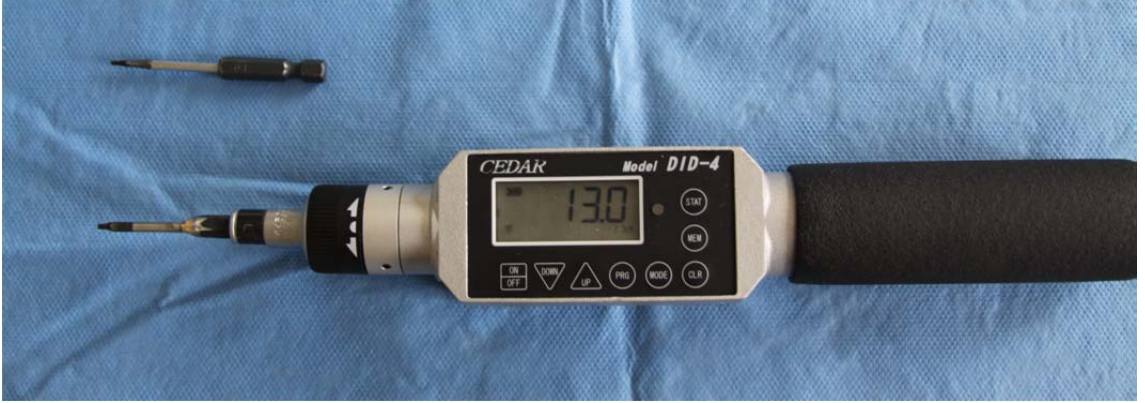
Resim 3.8: DID-4 aleti ve hazırlanan uçlar
