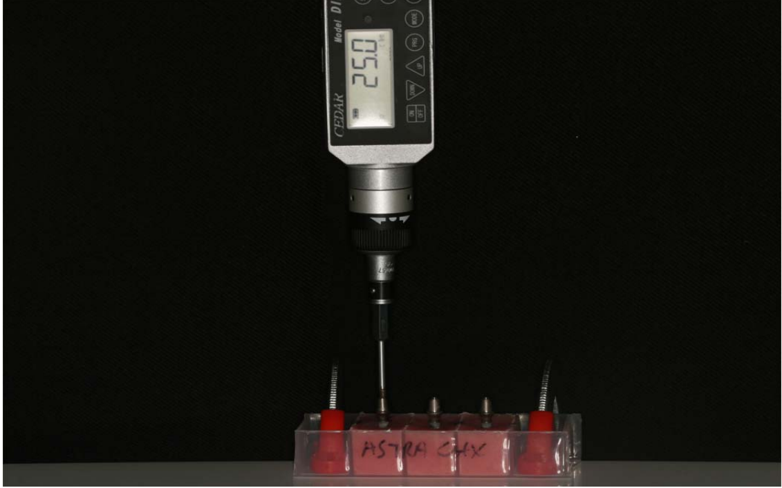
Resim 3.9: DID-4 aleti ile abutmentların geri sökülmesi
