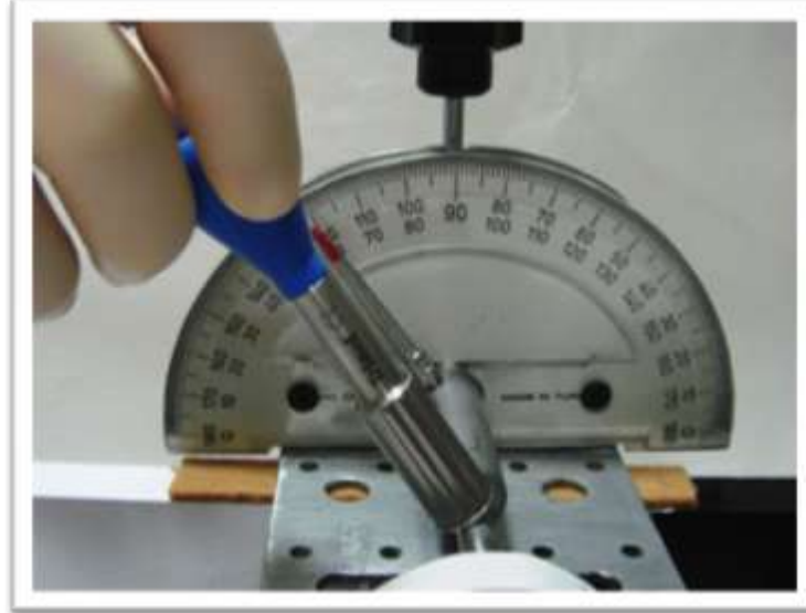
Resim 3.2.6.3: Açılı aparatın vida ile kemik yüzeyi arasında 60° açı yapacak şekilde ayarlanıp, minividanın uygulanması
