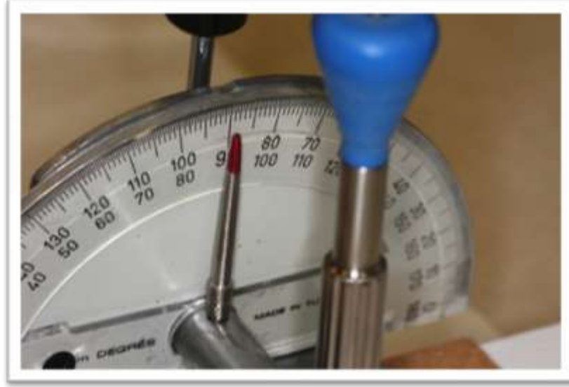
Resim 3.2.6.2: Açılı aparatın 90°'ye ayarlanması
