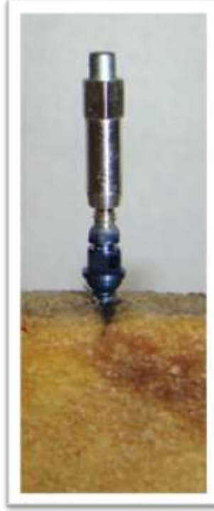
Resim 3.2.7.2: Minivida ile Smartpeg 'in uzun eksenleri birbirine paralel olacak şekilde bağlanması.
