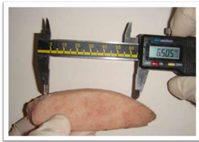
Resim 3.2.2.1.1: Kemik üzerinde uygulama mesafesinin sınırlarının ölçülmesi
