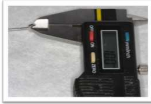
Resim 3.2.6.7: 1 mm'lik mesafenin dijital kaliper ile kontrol edilmesi
