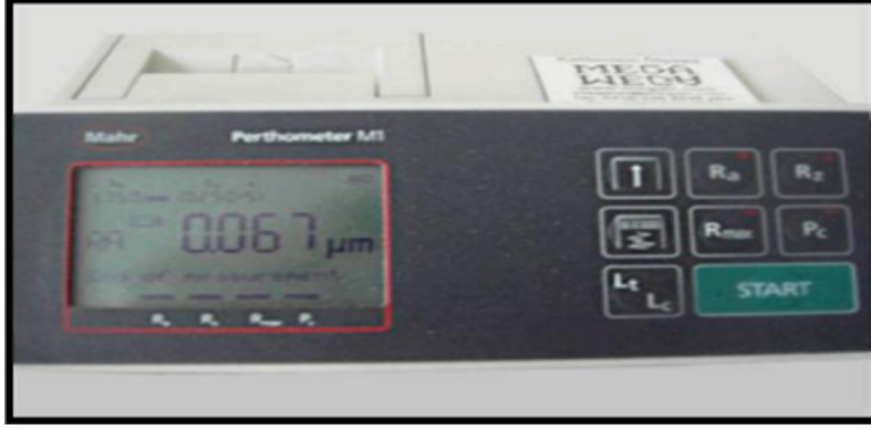
Resim 10. Profilometre cihazının ekranı.
