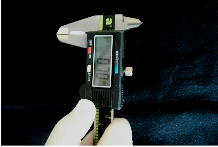
Resim 6. Dijital kumpas ile örneklerin ilk kalınlıklarının ölçümü.
