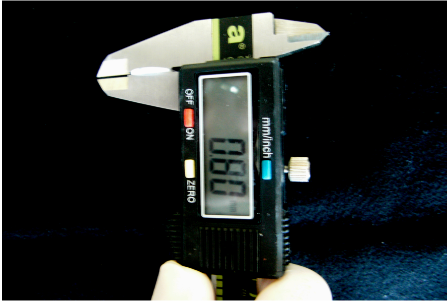
Resim 7. Dijital kumpas ile örneklerin ilk kalınlıklarının ölçümü.
