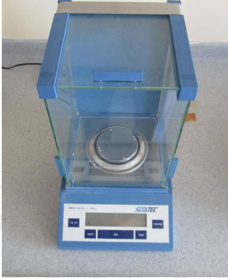
Resim 9 : Ağırlık ölçümleri Scaltex 0.0001g hassasiyetteki terazi ile yapılmıştır
