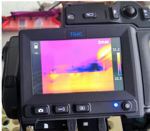
Resim 3.5. FLIR T640 termal kamera
