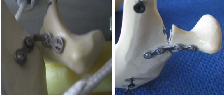
Resim 9-10. Titanyum plakta görülen kalıcı deformasyona örnekler. (75)
