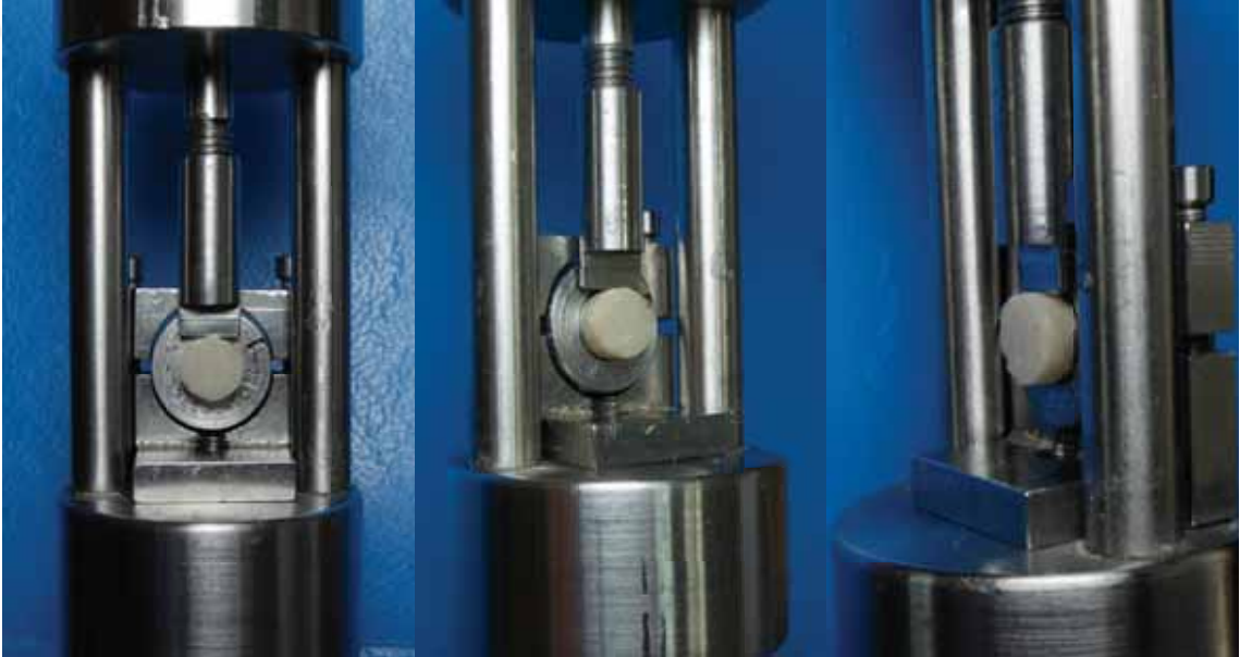
Resim 3.55 – Örneklerin Instron cihazında kırılması
