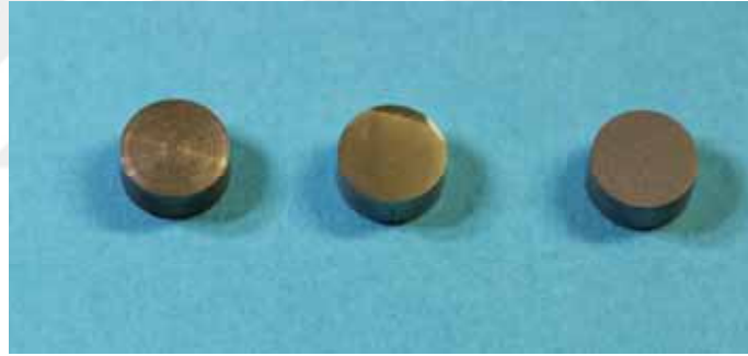
Resim 3.17 – Titanyum örneklerin zımpara öncesi, zımpara sonrası ve kumlama sonrası görünümleri
