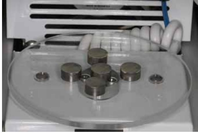
Resim 3.25 – GC Labolight LV-III ile opakerin polimerizasyonu
