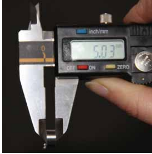
Resim 3.3 - Deney örneklerinin kesildikten sonra ölçümü
