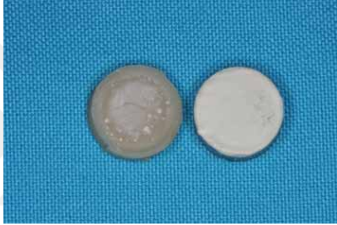
Resim 3.59 – Metal yüzeyinin tamamen resin ile örtülü olduğu Modified ARI (skor 3)
