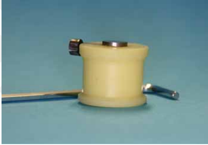
Resim 3.12 – Zımpara işlemi için plastik aparat
