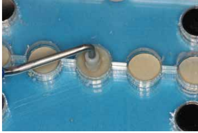
Resim 3.28 – Pleksiglass yuvalar içine 1 mm'lik kompozitin tepilmesi
