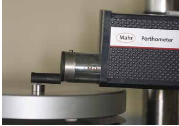
Resim 3.16 – Titanyum örneklerin yüzey pürüzlülüğü ölçümü
