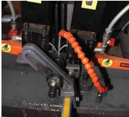
Resim 3.2 – Ti_6Al_4V su ve yağ ile kesilirken
