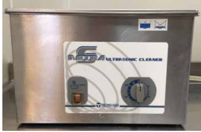
Resim 3.9 – Techno-Gaz Astra S ultrasonik temizleyici
