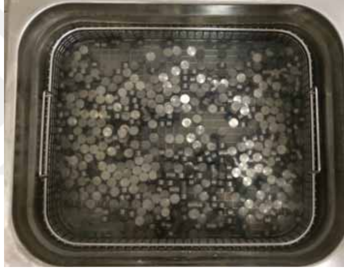
Resim 3.10 – Ti_6Al_4V disklerin ultrasonik temizlenmesi
