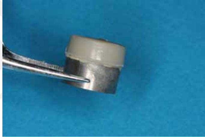
Resim 3.48 – Polimerizasyon sonrası pleksiglasstan çıkan örnek
