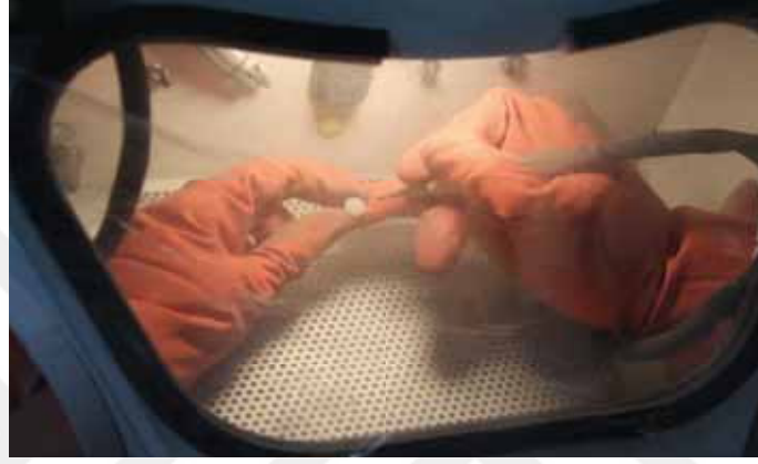
Resim 3.14 – Titanyum örneklerin kumlama işlemi
