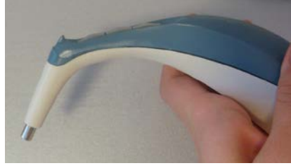
Resim 3.12 b Renk ölçüm cihazının elde tutulan parçası ve ölçüm ucu
