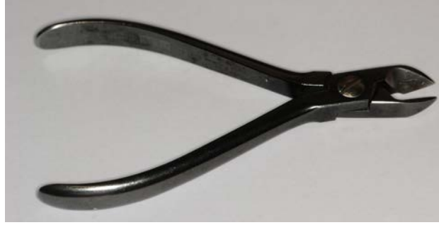
Resim 3.8. Braketlerin sökülmesinde kullanılan yan kesici pens
