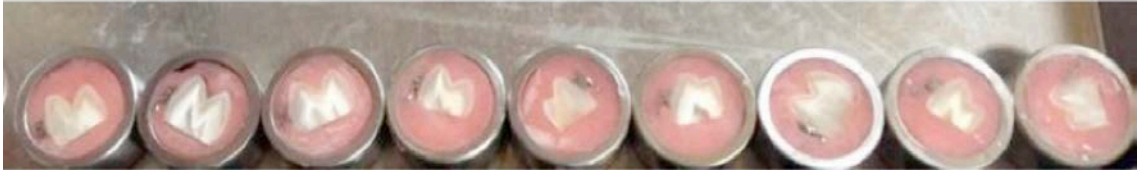
Resim 3. 15. Akrilik içerisine gömülmüş olan kesit örnekleri
