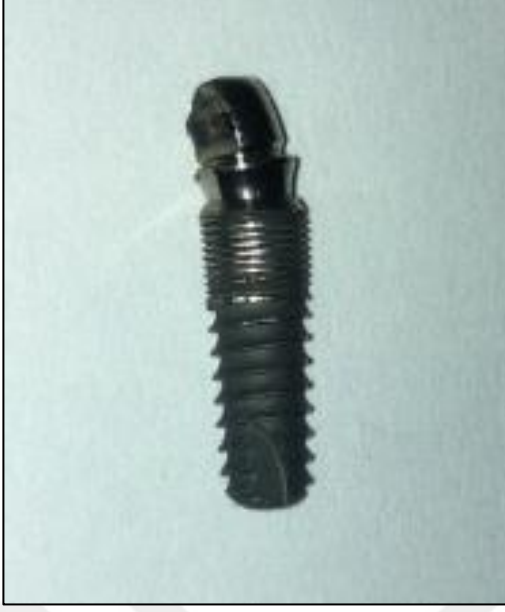
Resim 4.1: Abutment kural 1/3 kırılma örneği
