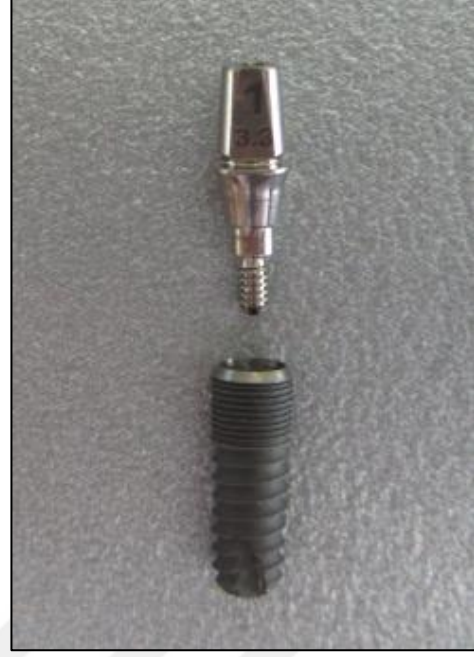
Resim 3.4: Arařtırmada kullanılan 2. Grup örneęi (solid abutment, 4,5 mm)
