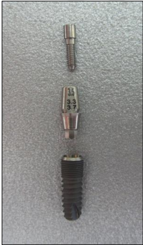
Resim 3.3: Arařtırmada kullanılan 1. Grup örneęi (solid abutment, 3,5 mm)
