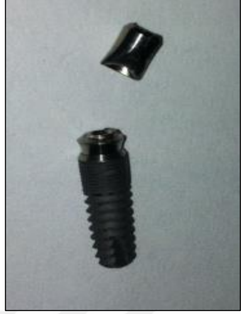
Resim 4.2: İmplant-abutment sınırı kırılma örneği
