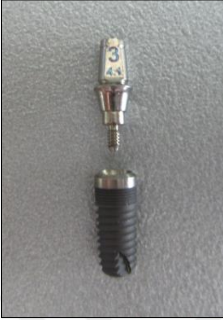
Resim 3.3: Arařtırmada kullanılan 1. Grup örneęi (solid abutment, 3,5 mm)
