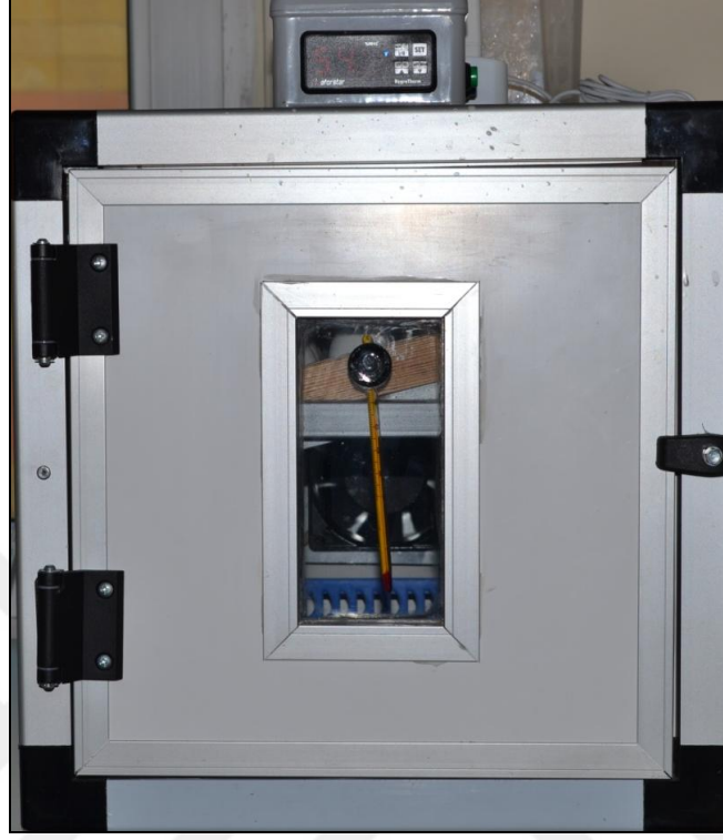
Resim 7. Eforstar dijital ısı ve nem sistemi ile kuluçka makinesi
