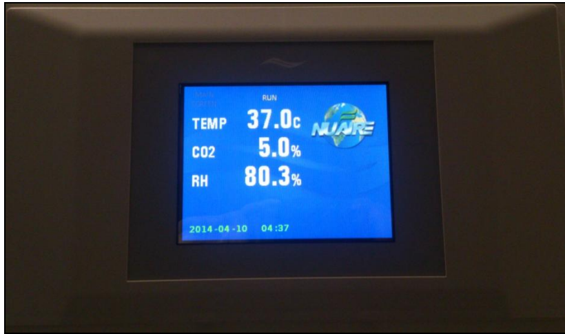
Resim 10. %5 CO 2 , %95 hava içeren inkübasyon makinesi (NuAire AutoFlow NU-8700 Dual Chamber Water Jacket CO 2 Incubator)
