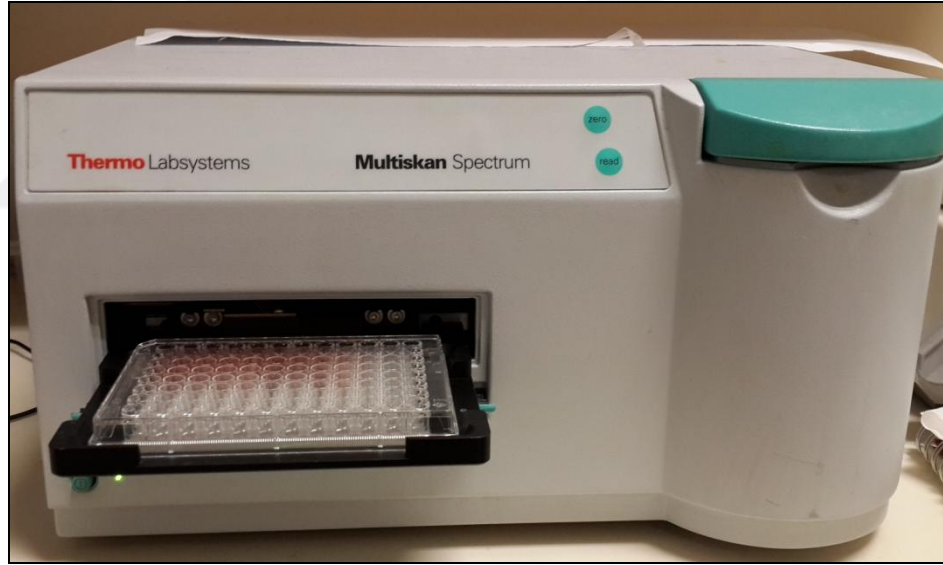
Resim 15. Otomatik petri okuyucu (Thermo Scientific Multiskan® Spectrum)
