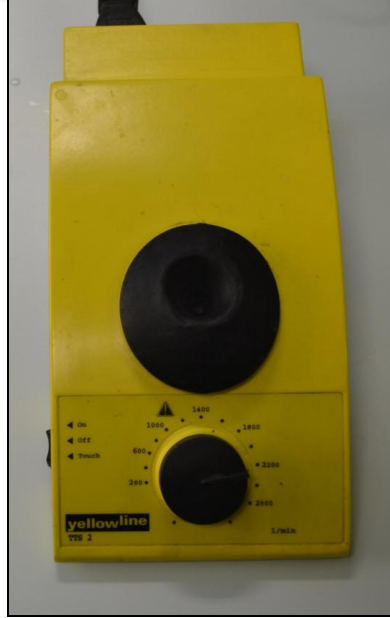
Resim 5. Çözeltilerin vortekslenmesinde kullanılan yellowline TTS 2 cihazı
