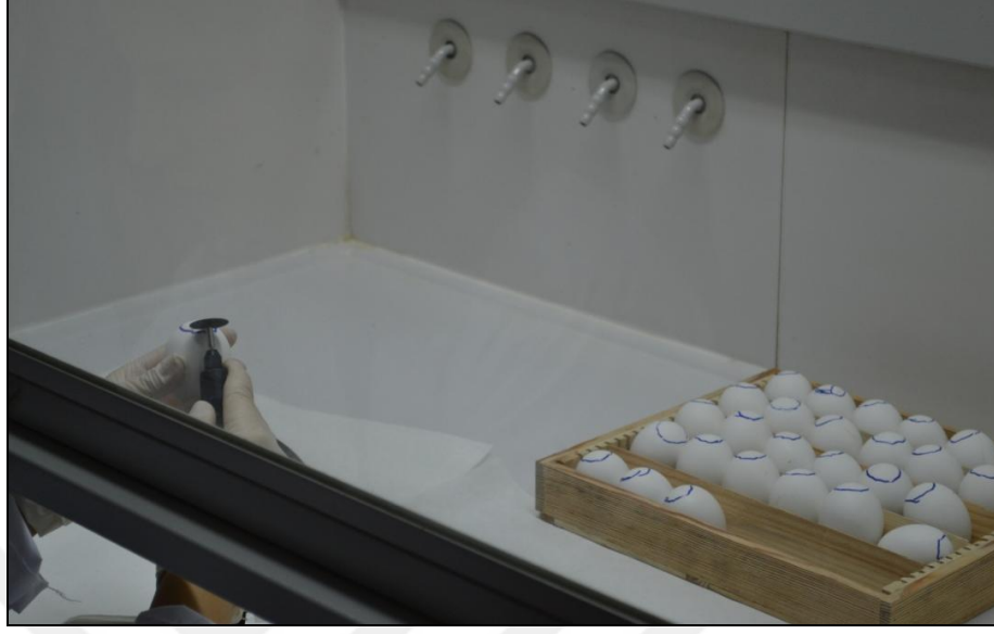
Resim 8. Hava boşlukları işaretlenmiş yumurtaların tur motoru ve separe ile kesilmesi
