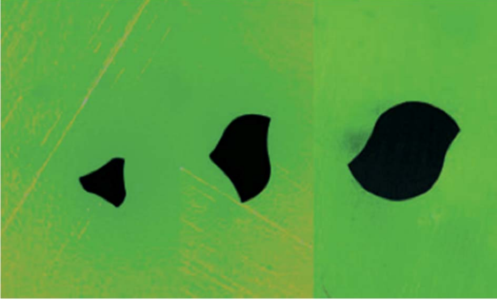
Resim 18: OneShape eęenin deęişken kesiti; uç kısmında 3 kesici uca sahipken (solda) koronal bölgede 2 kesici uca (saę) sahip kesit. (x45 büyütme ile) [143]
