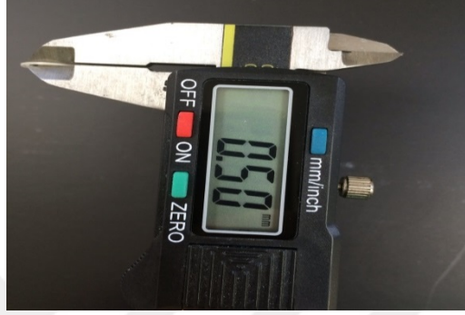
Resim 2: Altyapı Örneklerinin Kalınlıklarının Ölçülmesi
