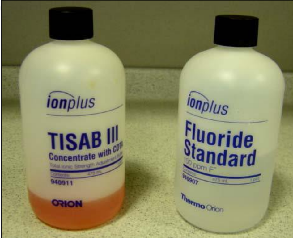
Resim 17 . Çalışmada kullanılan “Orion marka florid standardı (Orion Research, Inc. 500, Cummings Center, Beverly, MA, 01915-6199 USA, 940907) ve TISAB III (Orion Research;Inc.500, Cummings Center, Beverly, MA, 01915-6199 USA, 940911)
