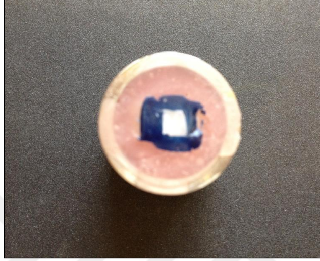
Resim 7. Mikrosertlik ölçümü için hazırlanmış örnek
