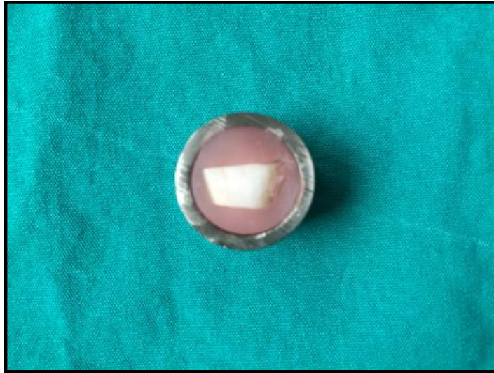
Resim 6: Metal blok içine gömülmüş ve zımparalanmış mine örneği
