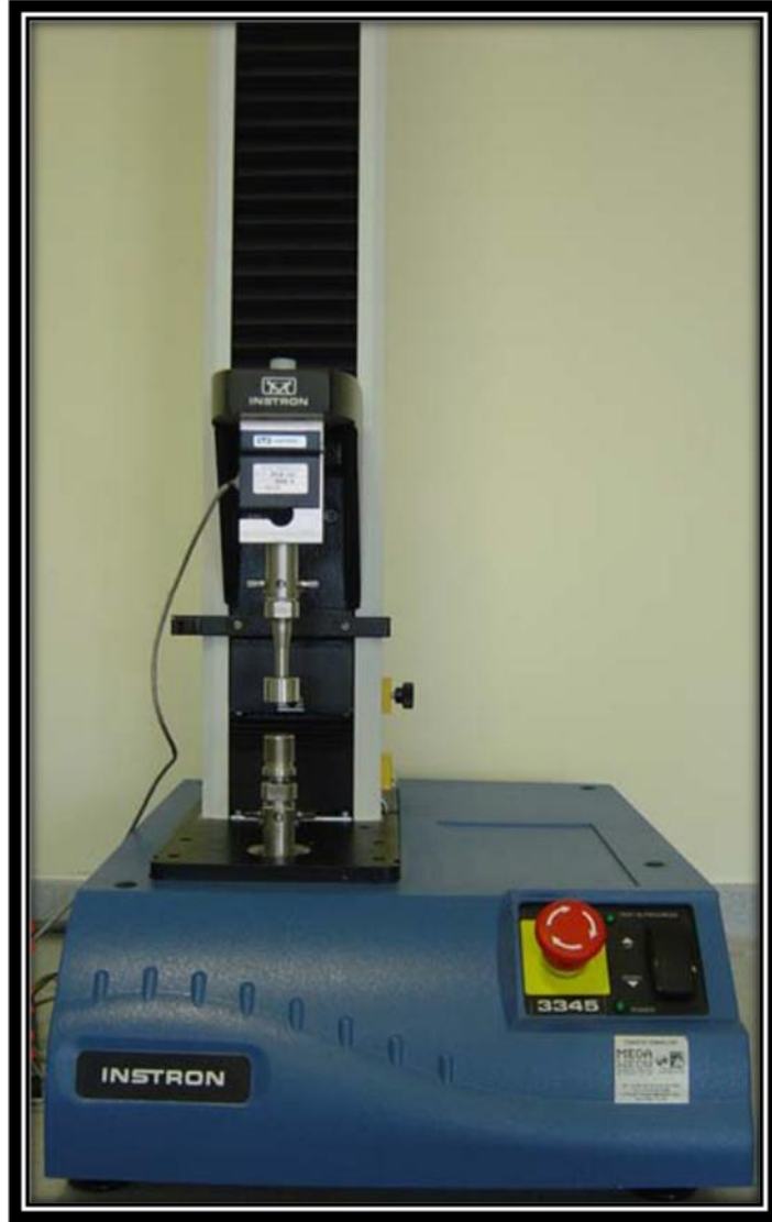
Resim 12: Basma dayanımı ölçümleri için kullanılan “INSTRON 3345 (3345J7324,USA)” cihazı
