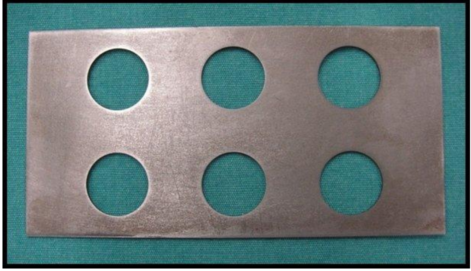
Resim 11. Su emilimi ve suda çözünlük deneylerinde kullanılan ISO 4049:2000 standartına uygun paslanmaz çelik kalıp
