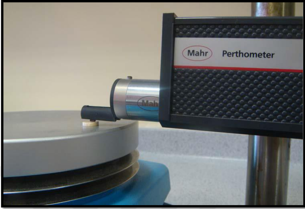
Resim 26. Örneklerin yüzey profilometresi ile yüzey pürüzlülüklerinin ölçülmesi
