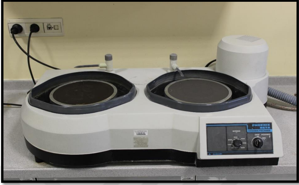
Resim 18. Örneklerin 1200 grid silikon karbit kağıt zımpara disk ile su altında zımparalanmasında kullanılan Buehler Phoenix Beta Grinder-polisher cihazı
