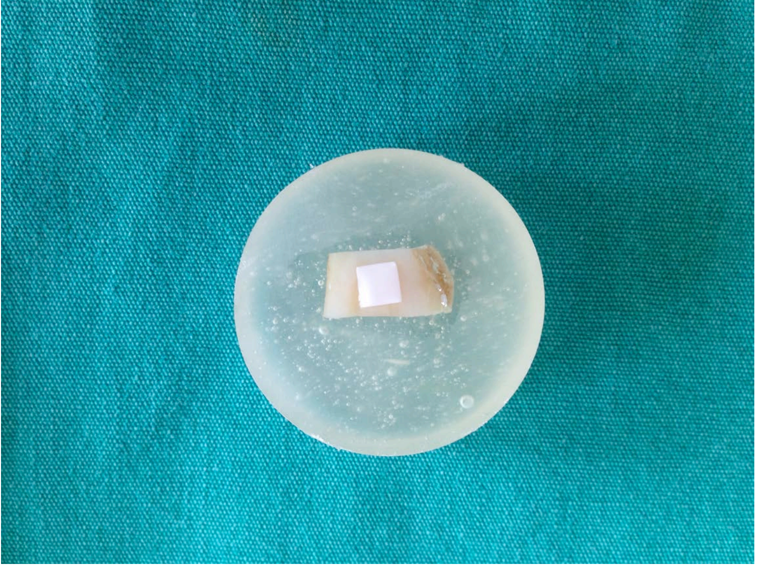
Resim 45. Akriğe gömülen ve yüzeyine 4x4 mm boyutunda yapıştırma uygulanan mine örnekleri
