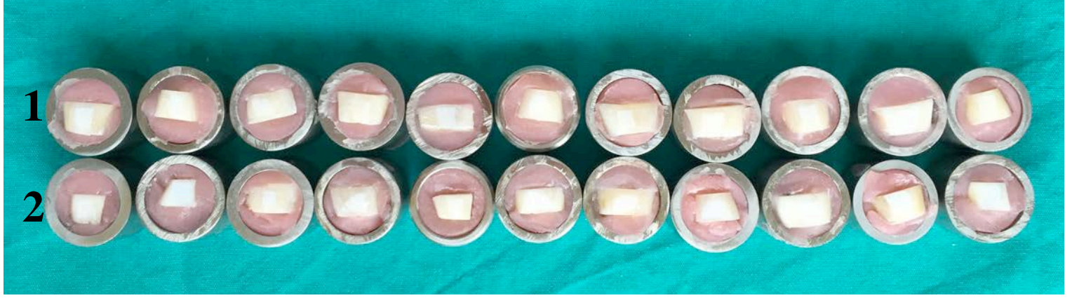
Resim 40. Demineralize edilen ve beyaz lezyon oluşturulan örnekler. Üstten birinci sıradaki örnekler demineralizasyon (1), ikinci sıradaki örnekler ise Icon® grubu (2)
