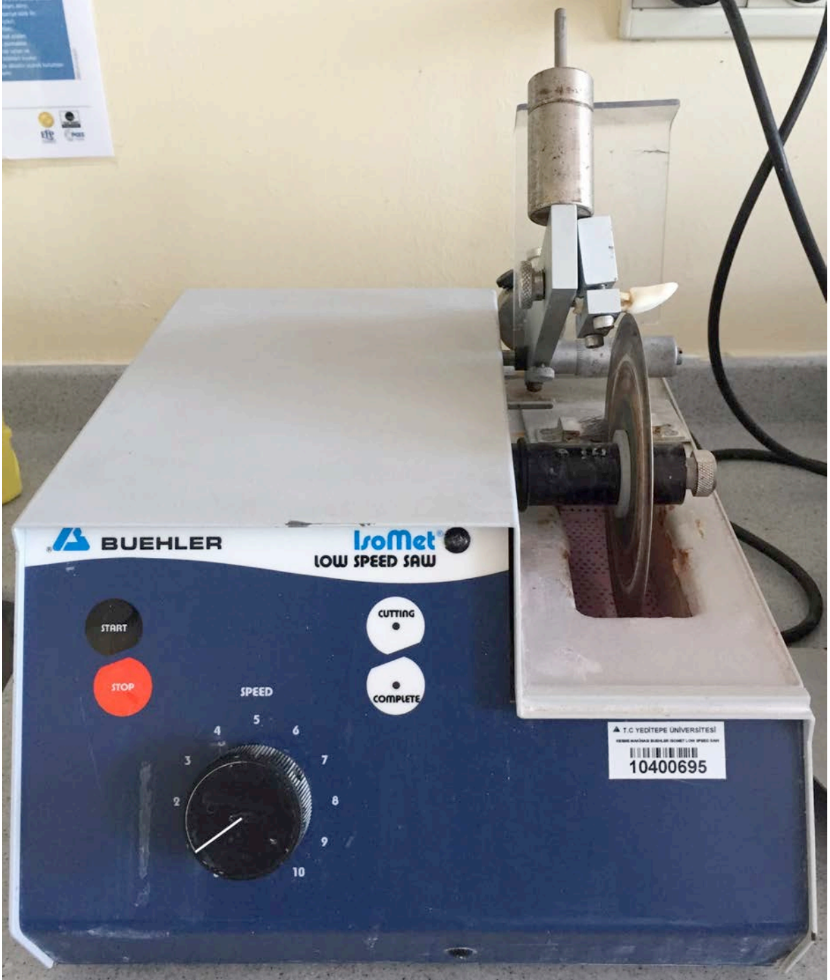
Resim 33. ISOMET cihazı ile sığır dişlerinin kesilmesi
