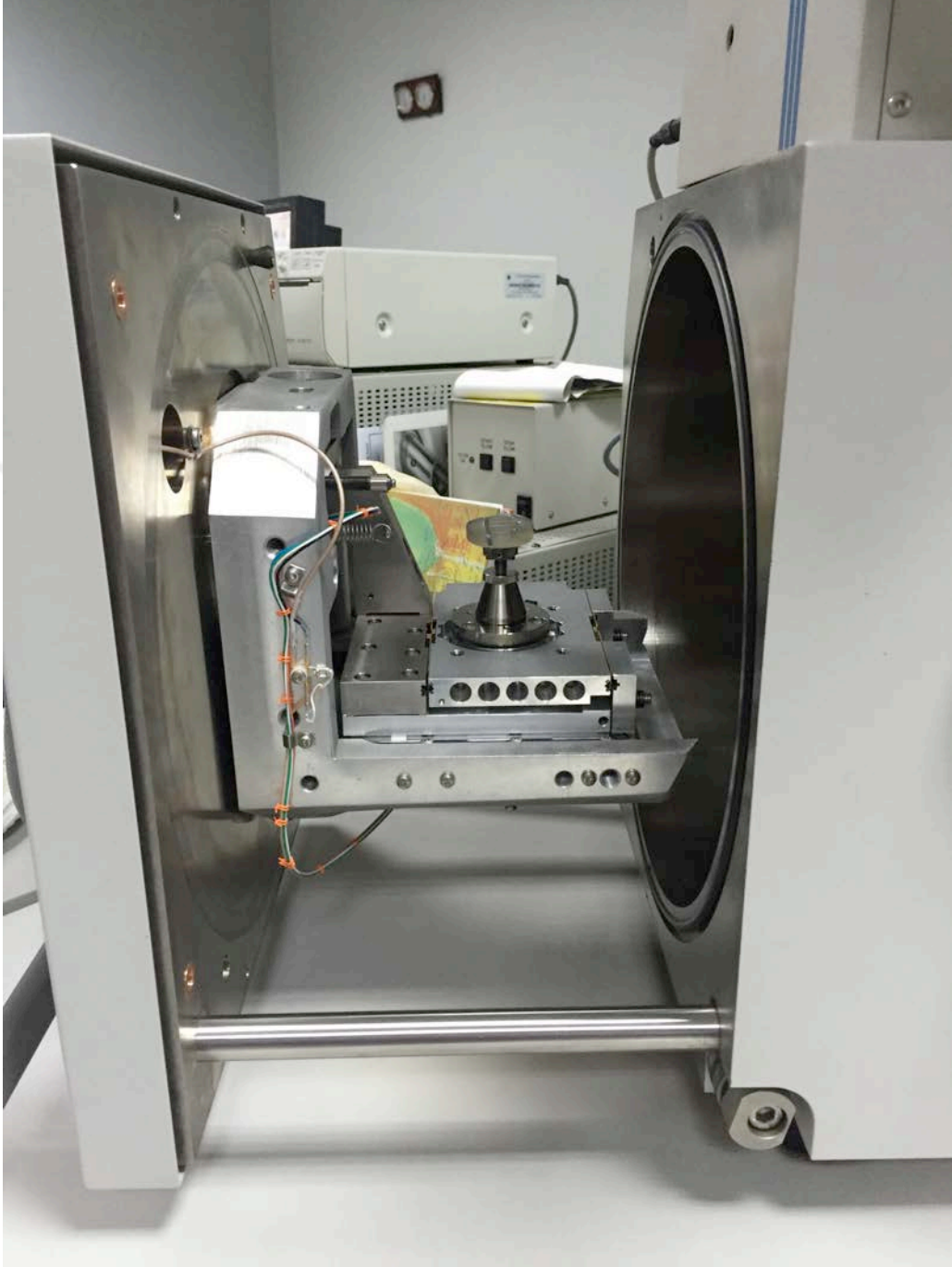
Resim 59. Platin ile kaplanan örneğin SEM cihazına yerleştirilmesi
