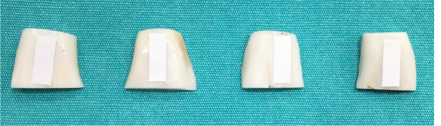
Resim 53. Cilalanan ve üzerine 4x10 boyutunda yapıştırma uygulanan mine örnekleri
