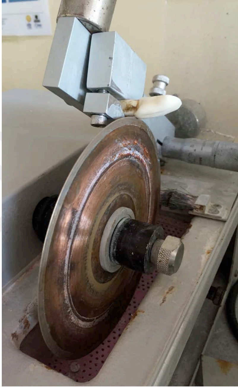
Resim 51. ISOMET ile kesilen sığır dişleri
