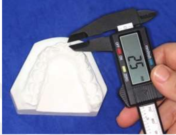
Resim 3.9: Little'ın çapraşıklık indeksinin dijital kaliper ile ölçümü.
