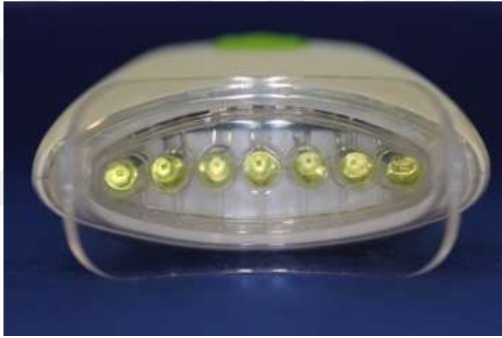
Resim 3.3: Fotobiyomodulasyon özellikli aygıtın LED ışık kaynağının karşıdan görünümü.
