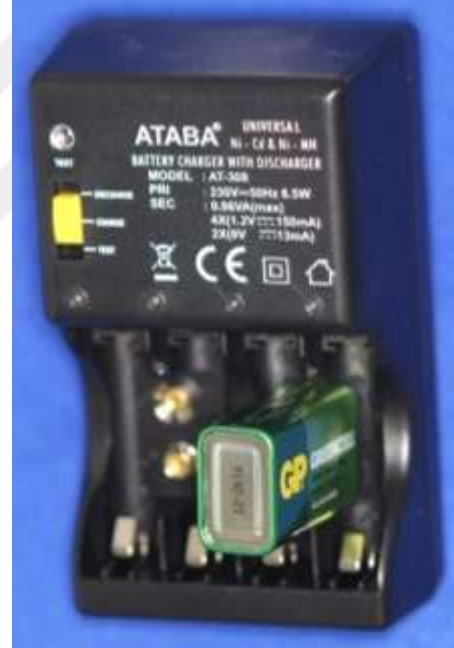
Resim 3.6: Kullanılan şarj edilebilir pil ile şarj edilebilen pillerin şarj ünitesi.
