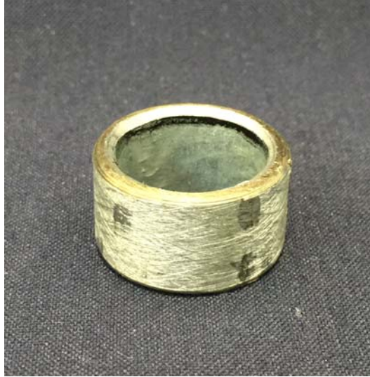
Resim 3.3. Metal halkaların iç duvarının 10 mm yükseklikte işaretlenmesi
