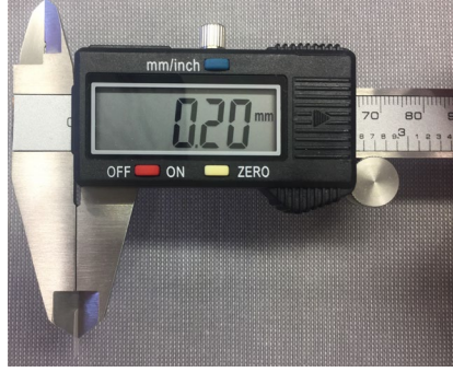
Resim 49: Rezin siman örneklerin kalınlıkları dijital kumpas ile kontrol edildi.
