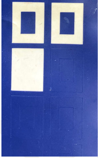
Resim 45: Rezin siman örneklerin hazırlanması için yapışkanlı kağıttan kalıp.
