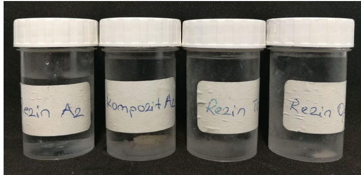
Resim 62: Kompozit ve resin siman örneklerin distile suda bekletilmesi.
