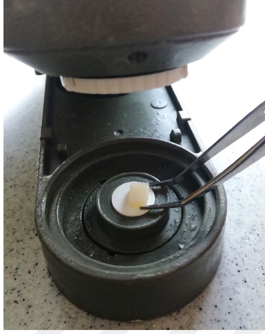
Resim 59: Spektrofotometrede örneklerin beyaz zemine yerleştirilmesi.
