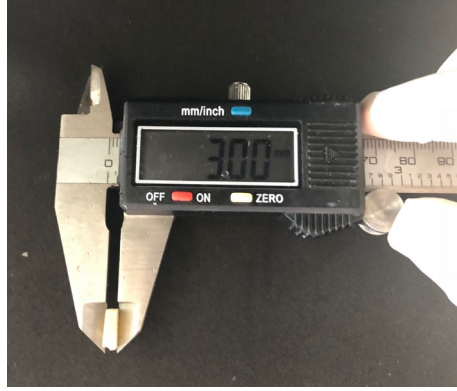
Resim 43: Kompozit örneğin kalınlığı dijital kumpas ile kontrol edildi.
