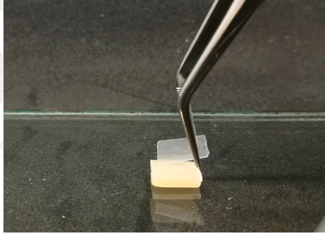
Resim 54: Kompozit örnek üzerine optik jel uygulanmasının ardından rezin siman örneğin yerleştirilmesi.
