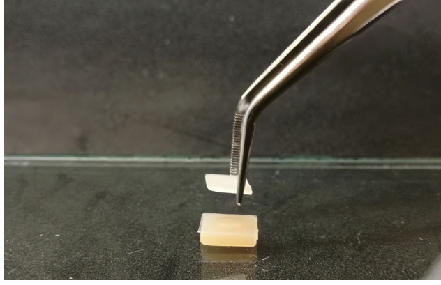
Resim 56: Rezin örnek üzerine optik jel uygulamasının ardından CAD/CAM materyal örneğinin yerleştirilmesi.
