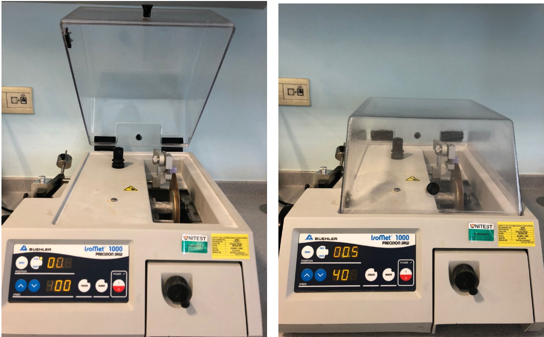
Resim 25, 26: EM CAD/CAM Bloklarının düşük devirde su soğutması altında kesilmesi
