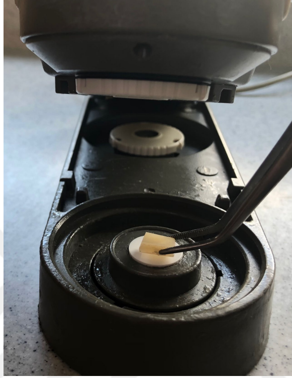
Resim 52: Kompozit örneğin spektrofotometrede ölçülmesi.
