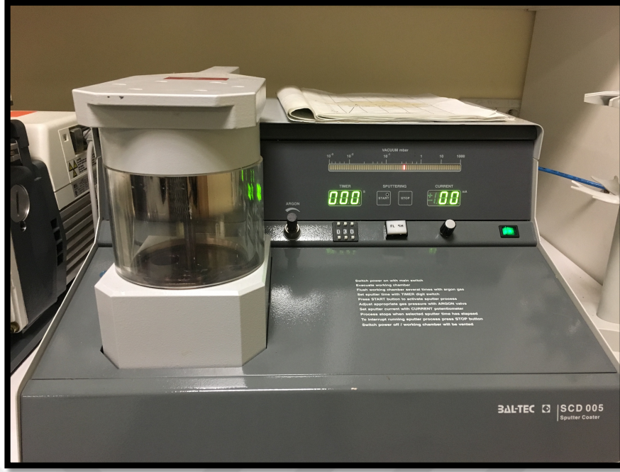
Resim 25. Örneklerin altın nanopartikülleriyle kaplanması (Sputter Coater®, BalTec SCD 005, İsviçre)
