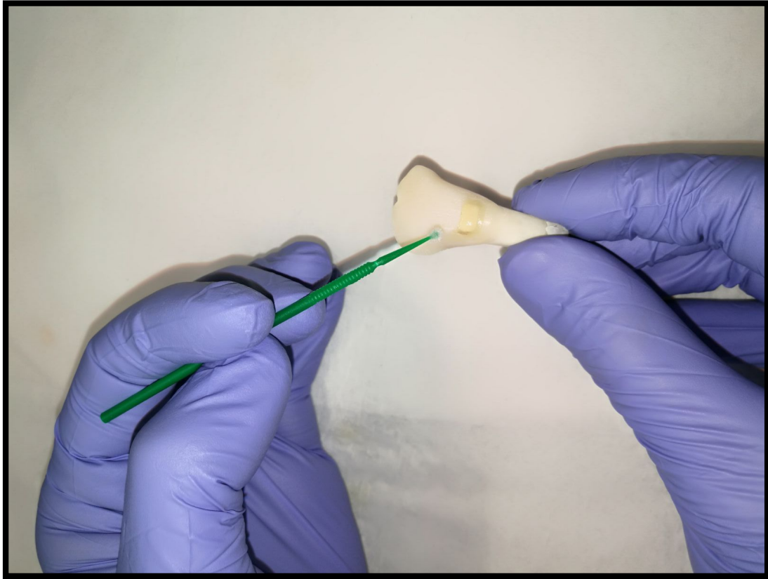
Resim 31. Örneklere yüzey örtücü uygulanması
