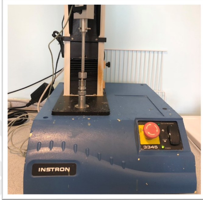
Resim 27. Basma dayanımı ölçümleri için kullanılan cihaz
