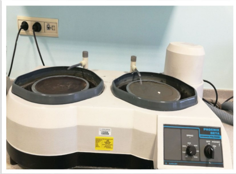
Resim 21. Örneklerin Buehler Phoenix Beta Grinder-polisher cihazında 1200 grid silikon karbit kâğıt zımpara disk ile su altında zımparalanması
