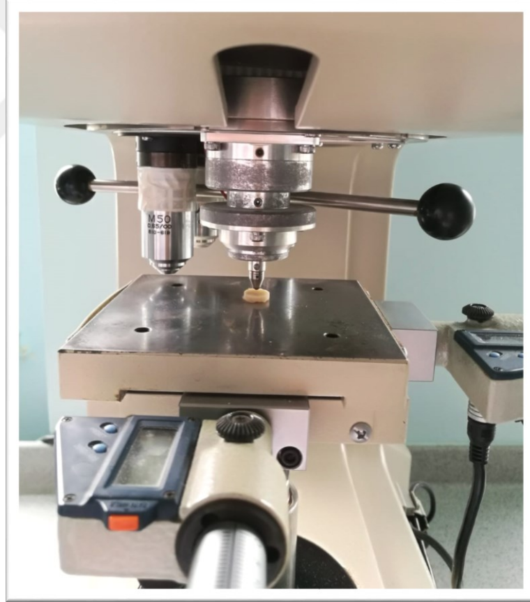
Resim 26. Örneğin belirlenmiş yüzeyinde Buehler Hardness Testing Machine cihazının kuvvet uygulayıcı ucu ile çentik oluşturulması ve Vickers sertlik değerinin hesaplanması
