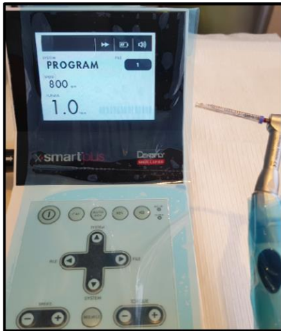
Resim 32: 800 rpm ve 1N tork ayarlı X-Smart Plus endodontik motor
