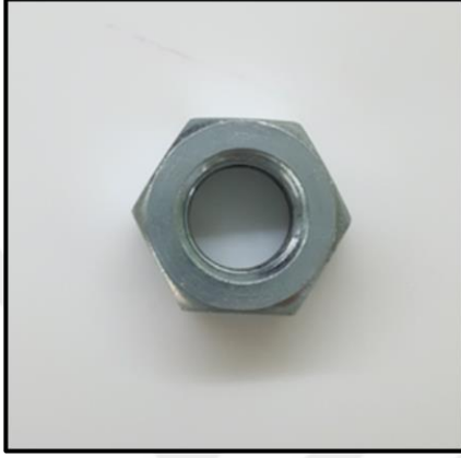
Resim 14: Örnek dişlerin silikon içerisine gömülmesi için kullanılan metal parça
