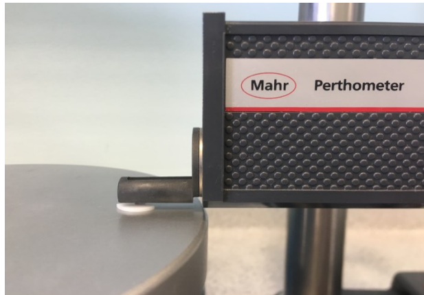
Resim 30: Yüzey Profilometresi (Perthometer M1, Mahr, Germany)
