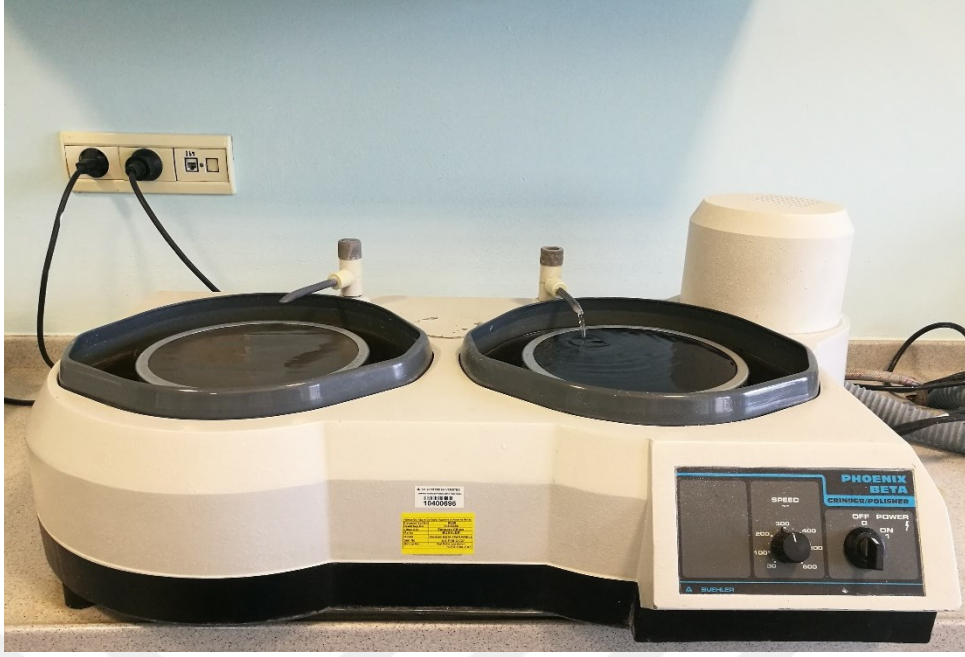
Resim 20 : Zımpara cihazı ( BUEHLER, Phoenix Beta Twin Wheel )
