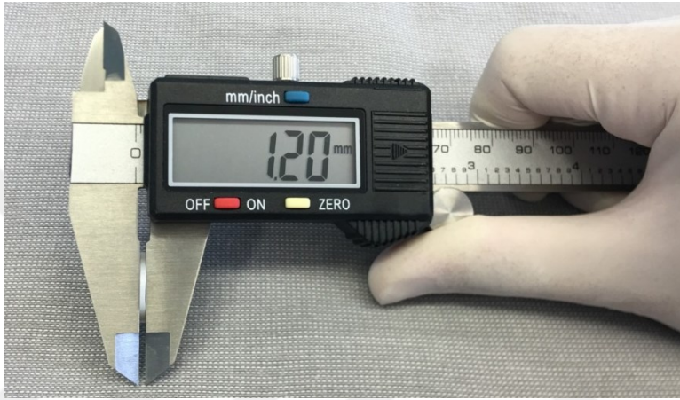
Resim 17: Kumpas ile örneklerin kalınlıklarının ölçülmesi
