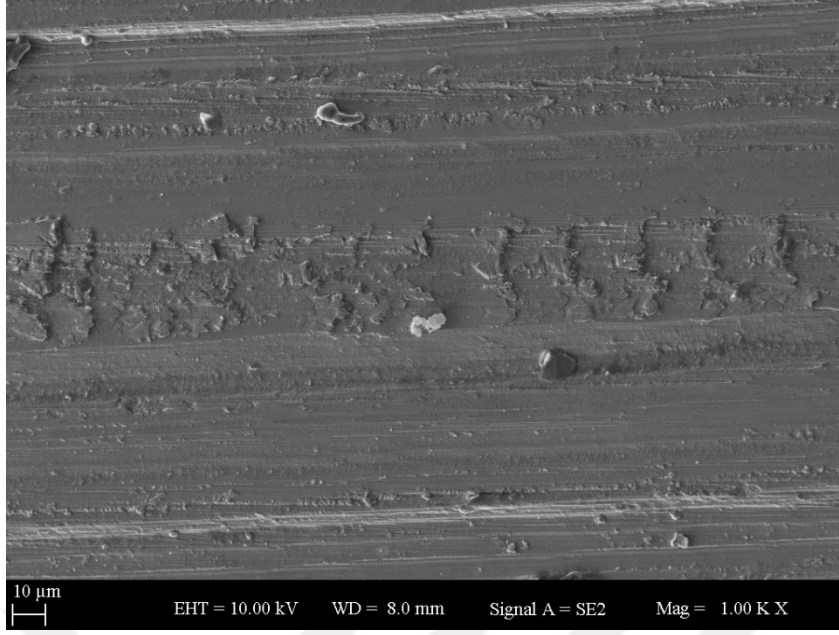
Şekil 51: GC (Mikromotor + 640 frezi +sulu ) örneğinin 1.000 büyütmeli SEM görüntüsü
