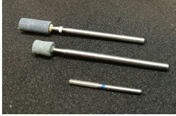
Resim 11 : Çalışmamızda kullanılan aşındırıcı frezler
