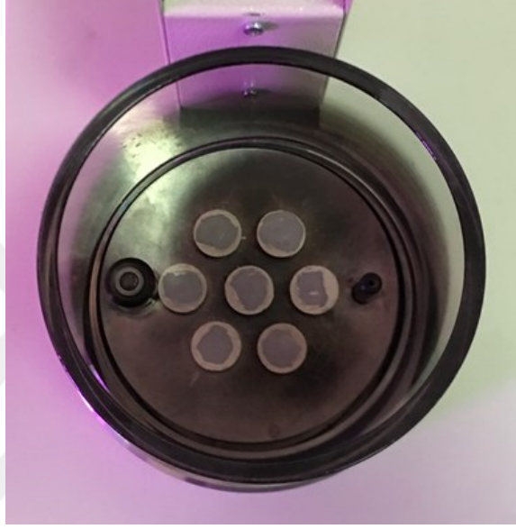
Resim 35: Örneklerin SEM analizi için kaplanması
