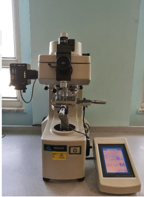
Resim 33 : Mikrosertlik cihazı (BUEHLER - Micromet 5114D)
