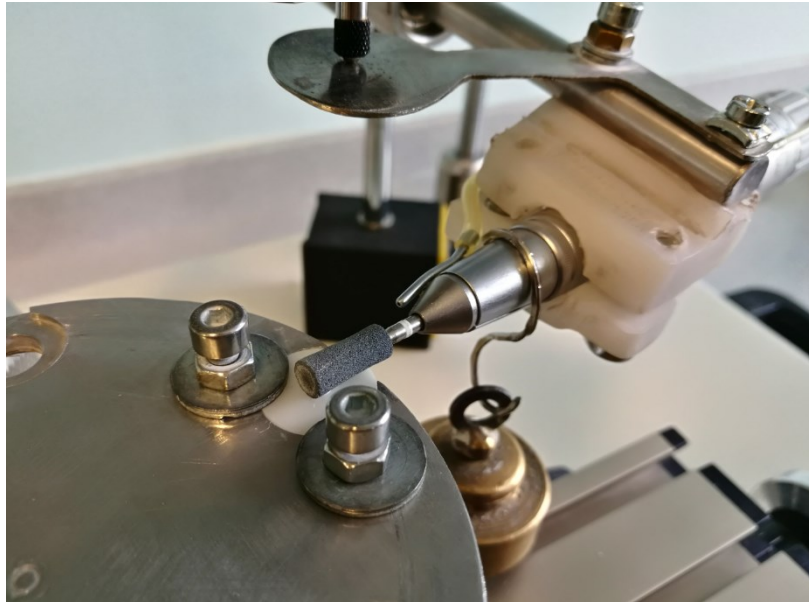
Resim 24 : Mikromotorun aşındırma cihazına monte edilmesi
