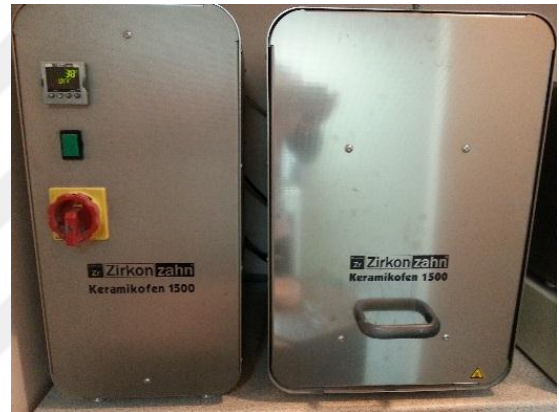
Figure 13: Furnace for zirconia sintering ZIRKONZAHN Keramikofen 1500
