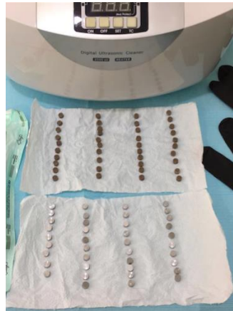
Şekil 3- 3: Örneklerin ultrasonik cihaz ile temizlenmesi
