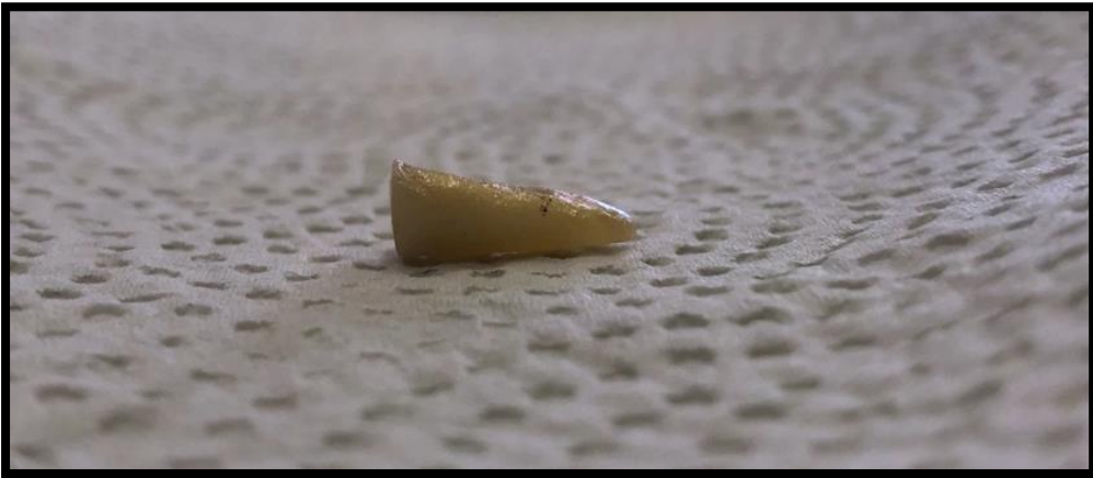
Şekil 18 : Kök yüzeylerinde hazırlanan yapay defektlerin yandan görünümü
