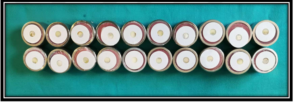
Resim 17: Kaide materyali uygulanırken kullanılan 1,5 mm çaplı teflon kalıplar
