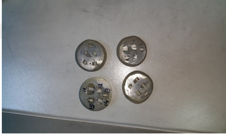
Resim 10b. Çalışma bakalitlerinin kodlandırılıp karbon bant ile alüminyum modüllere yapıştırılması
