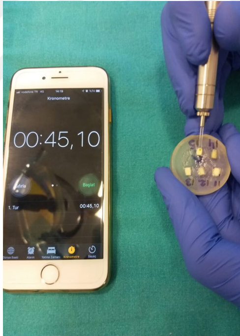
Resim 8c. E grubundaki numunelere 30°'lik açıyla, 45 sn, kontakt olarak su soğutması altında Er:YAG lazer aletinin uygulanması
