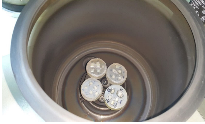
Resim 10c. Platin ile kaplanan örneklerin SEM cihazının vakum çemberine yerleştirilmesi
