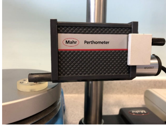
Resim 9b. Profilometre cihazı ile her bir numunenin yüzey pürüzlülüklerinin ölçülmesi
