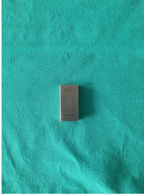
Resim 9d. Cihazın kalibre edilmesinde kullanılan önceden yüzey pürüzlülük değeri belirlenmiş olan test numunesi
